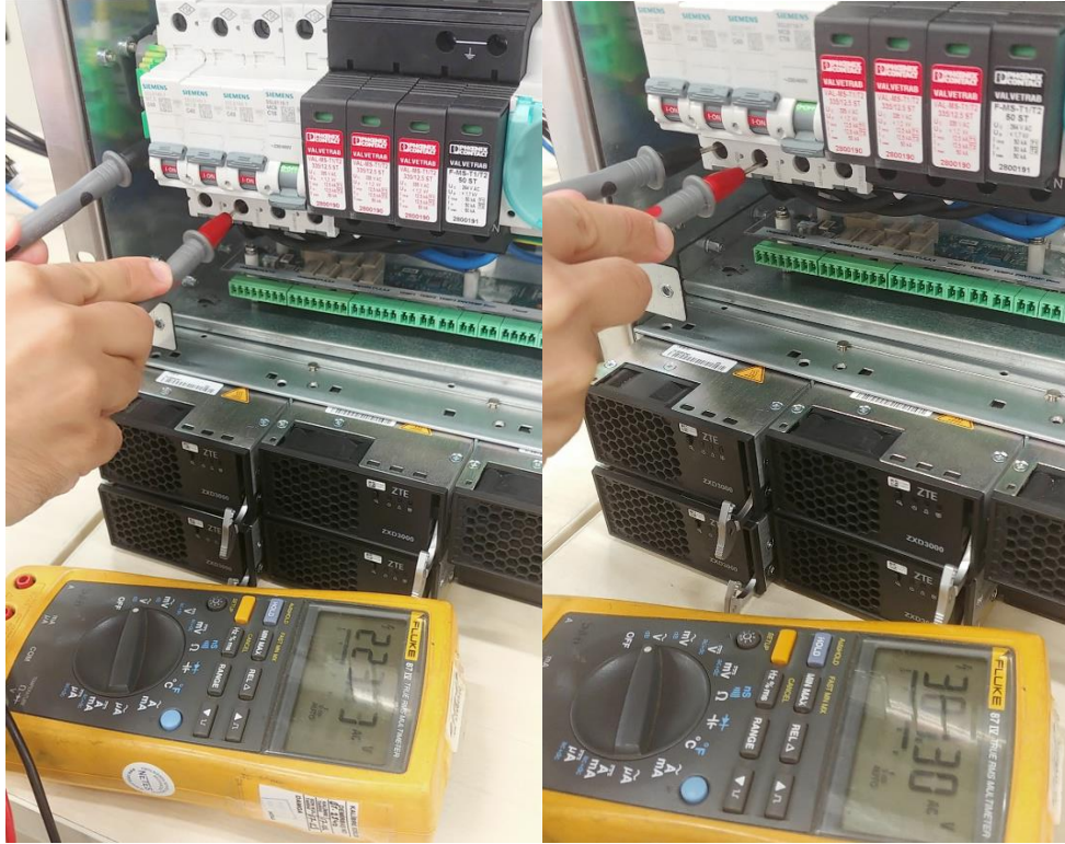
Şekil 4 220V AC çıkış kontrolü
