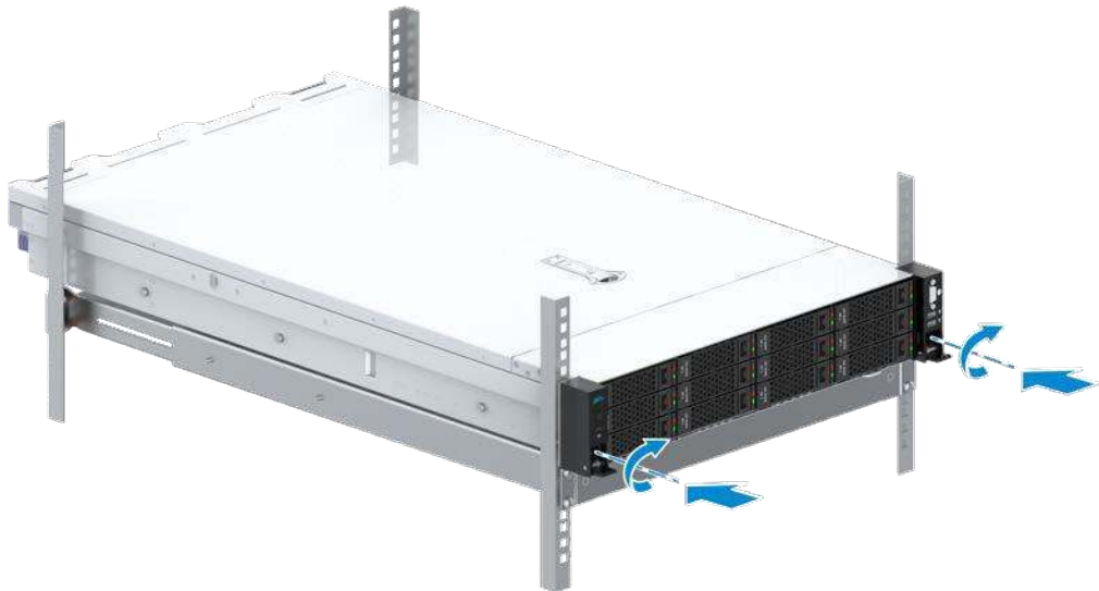
Şekil 12-82 Bir Sunucunun Sabitleme Vidalarının Monte Edilmesi
