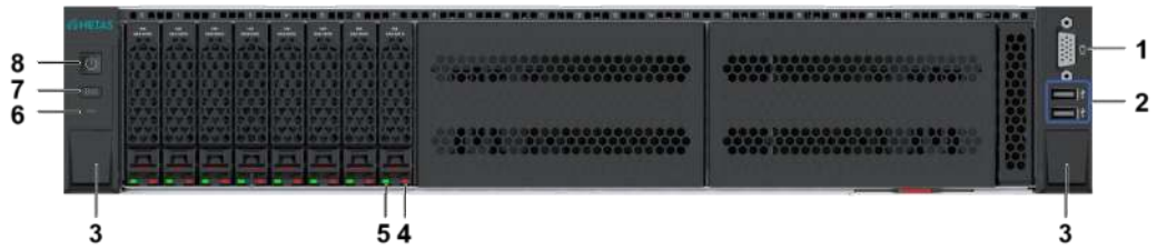
Şekil 2-4 Sekiz Dikey Disk Slotuyla Ön Panel
