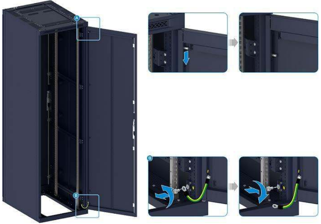
Şekil 12-6 PE Kablosunun Sökülmesi
