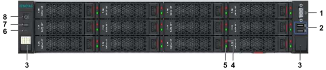
Şekil 2-3 On İki Yatay Disk Slotuyla Ön Panel
