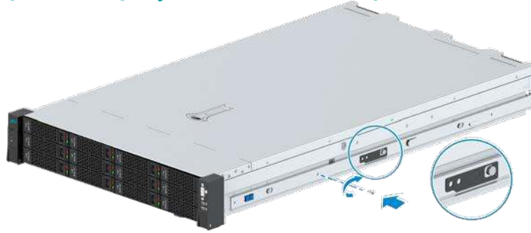
Şekil 12-57 İç Rayların Sabitlenebilmesi için Sabitleme Vidalarının Monte Edilmesi
