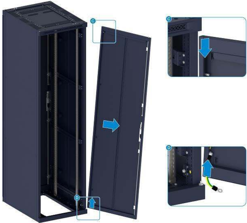
Şekil 12-32 Kabinet Kapısının Sökülmesi
