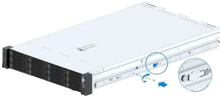
Şekil 12-69 İç Rayların Sabitlenebilmesi için Sabitleme Vidalarının Monte Edilmesi
