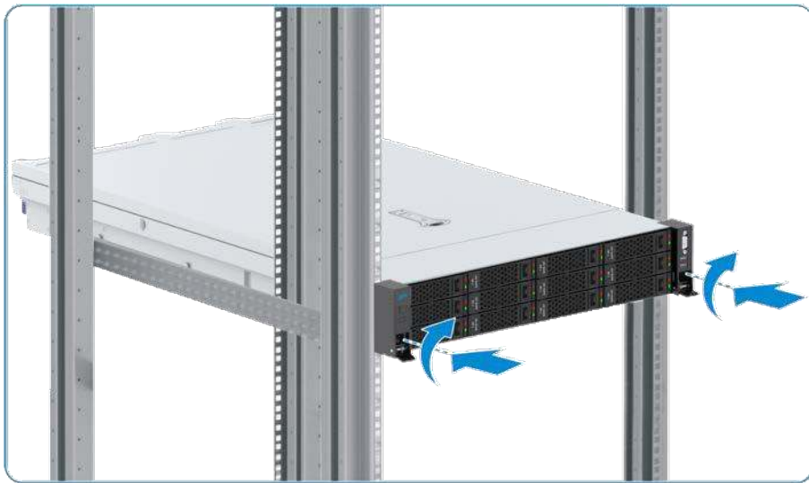
Şekil 12-87 Bir Sunucunun Sabitleme Vidalarının Monte Edilmesi
