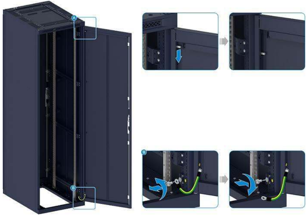
Şekil 12-31 PE Kablosunun Sökülmesi
