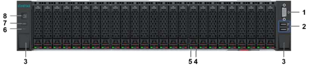
Şekil 2-7 Yirmi Beş Dikey Disk Slotuyla Ön Panel
