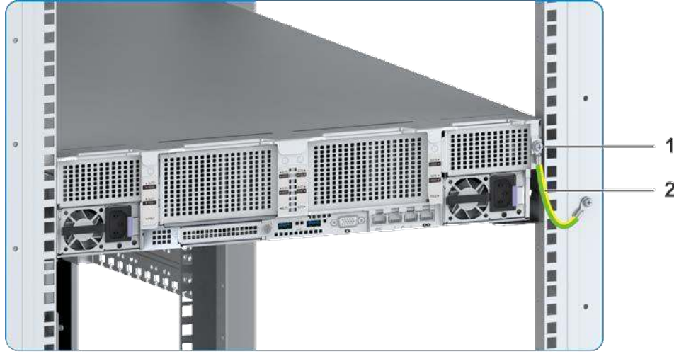
Ş ekil 13-4 Bir PE Kablosunun Bağ lanması
