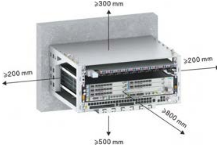
Şekil 9-1 VC9181 Kabineti için Tavsiye Edilen Kurulum Alanı
