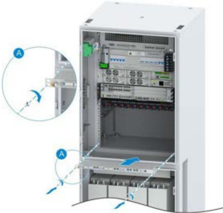
Şekil 15-19 VC9910A Kabinetine LPU2'nin Kurulumu
