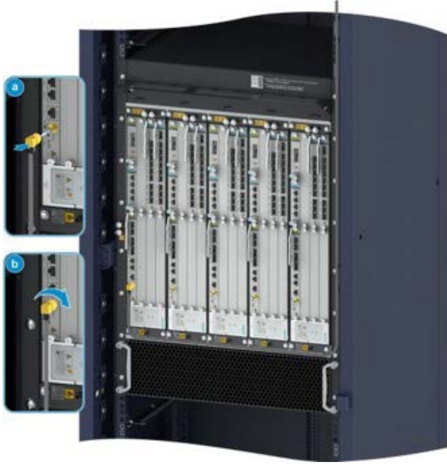
Şekil 11-10 GPS Jumper Kablosunun Bağlanması
