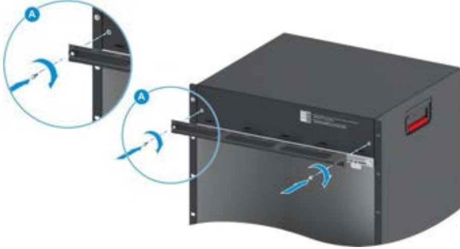
Şekil 11-2 Kablo Tavasının Kurulumu
