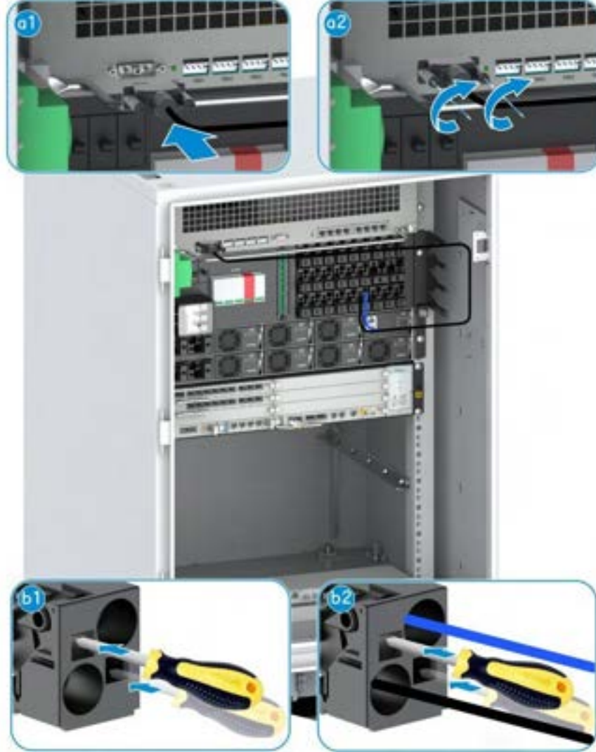
PC9910A-Li Kabinetinin Güç Kablosunun Takılması
