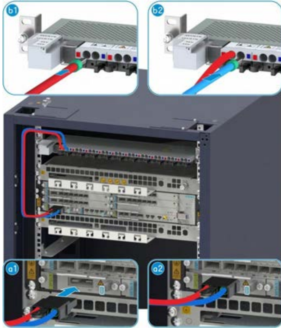
Şekil 13-28 Güç Kablosunun Takılması
