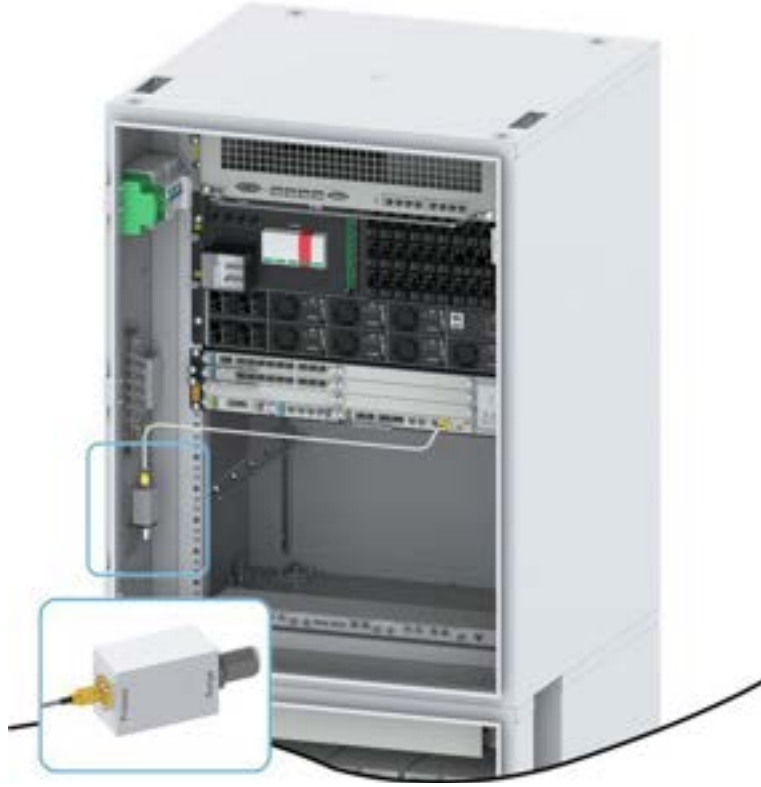
Şekil 15-71 RF Kablosunun CH1 Arayüzüne Bağlanması
