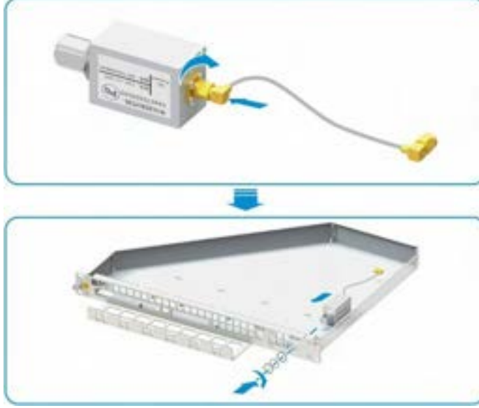
Şekil 12-19 Güç Bölme Biriminin Kurulumu (2)
