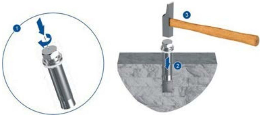
Şekil 14-3 Bir Dübelli Cıvatanın Takılması
