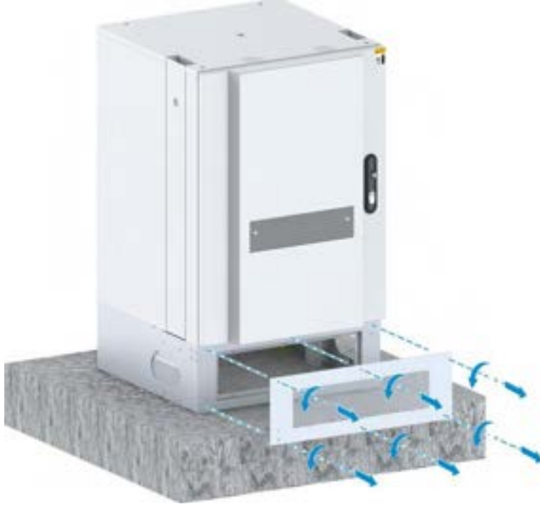
Şekil 15-9 Bazanın Ön Panelinin Sökülmesi
