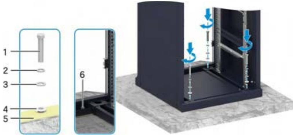
Şekil 12-5 Kabinetin Doğrudan Zemine Kurulumu
