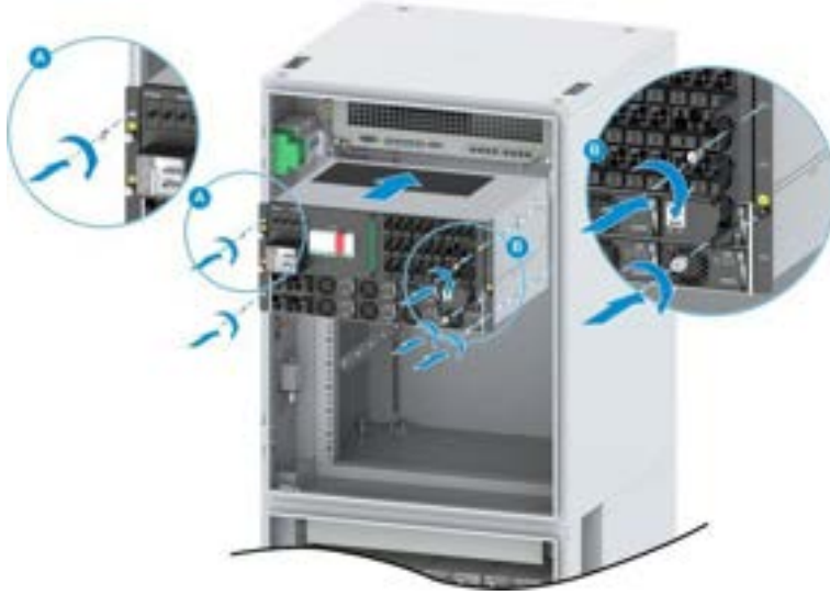
Şekil 15-21 VC9910A Kabinetine B351'in Kurulumu
