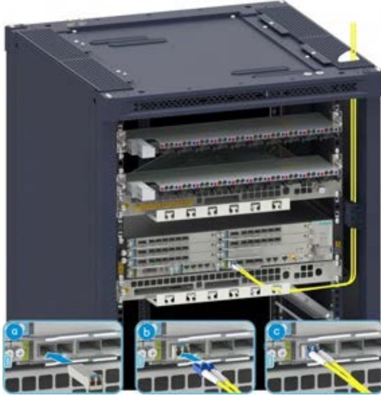
Şekil 12-29 VSW Kartına Optik Fiber Kablonun Bağlanması
