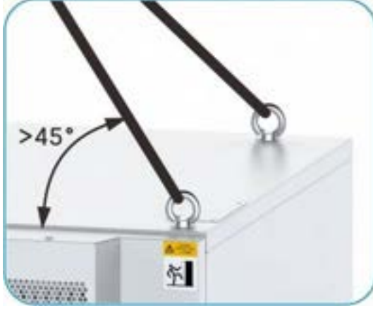
Şekil 16-2 Kabinet Kaldırma Gereksinimi
