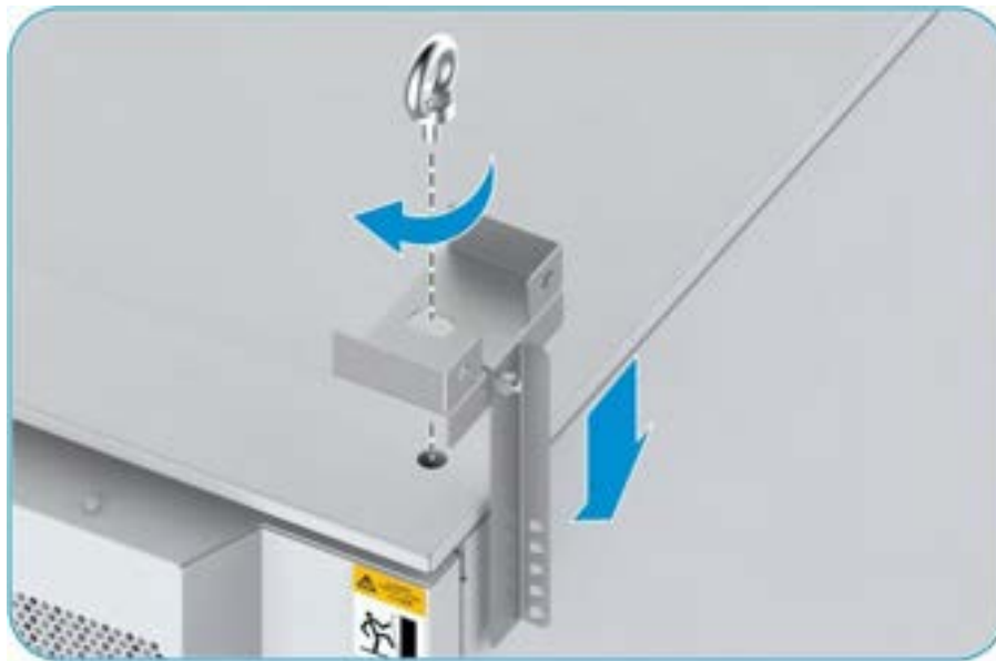
Şekil 16-22 Aksesuarların Kabinetin Üstüne Sabitlenmesi
