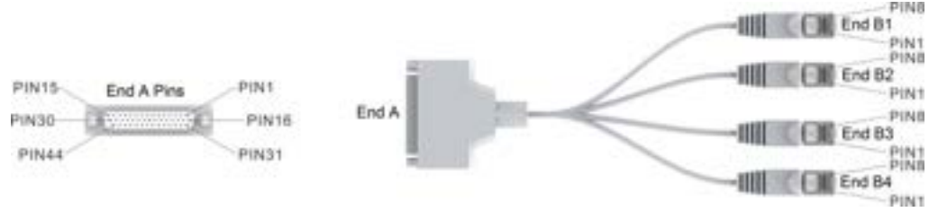
Şekil 4-8 VEMc1w Kartının Kuru Kontak Kablosu
