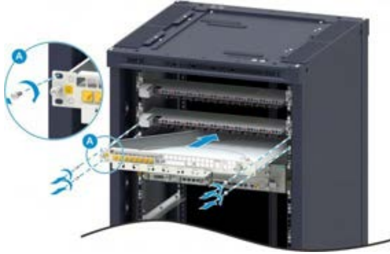
Şekil 12-20 Güç Bölme Biriminin Kurulumu
