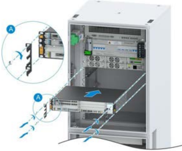
Şekil 15-17 VC9910A Kabinetine ZXRAN V9200'ün Kurulumu
