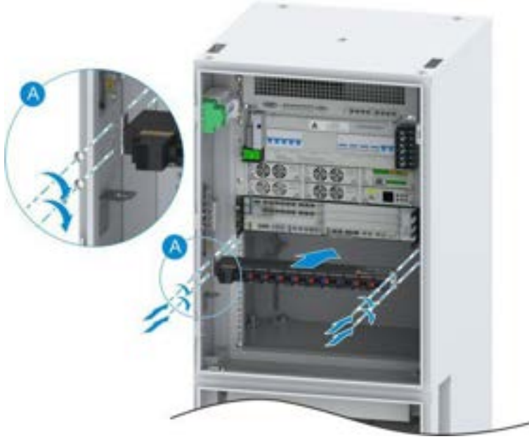
Şekil 15-18 VC9910A Kabinetine DCPD10C'nin Kurulumu
