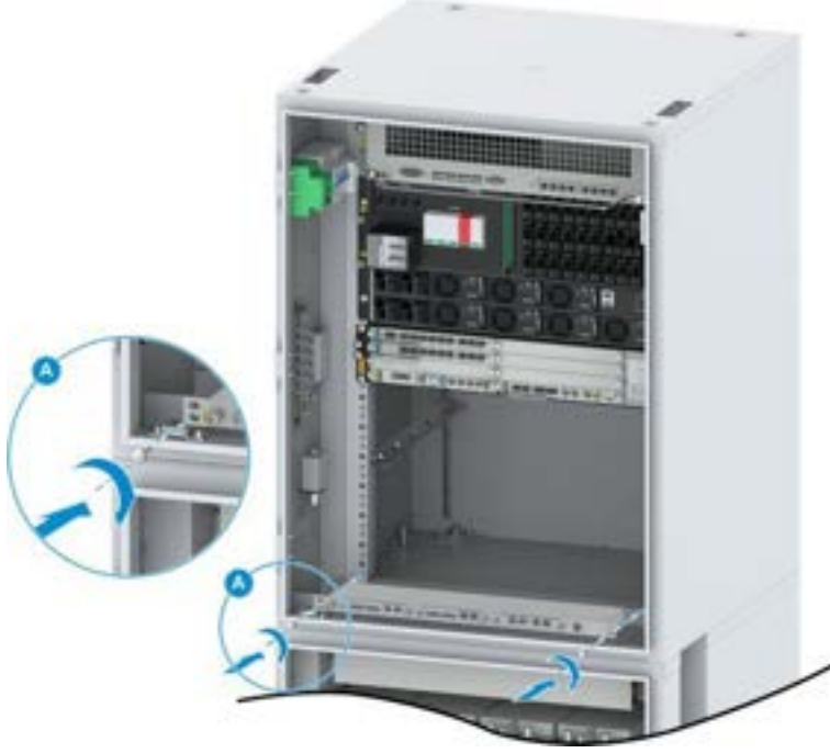
Şekil 16-19 VC9910A Kabinetine LPU2'nin Kurulumu
