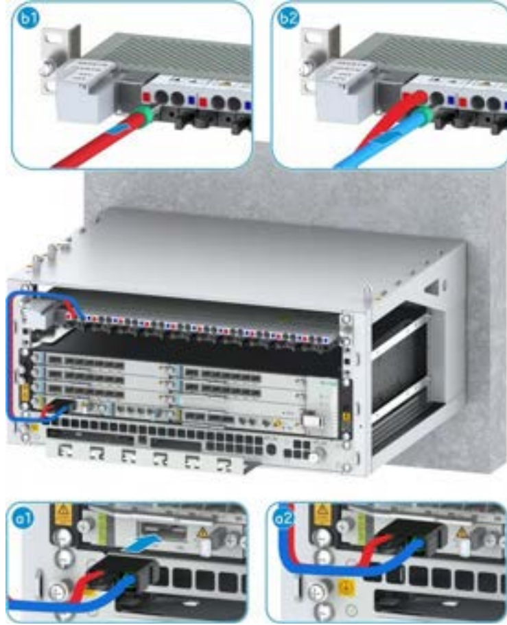
Şekil 9-26 Güç Kablosunun Takılması
