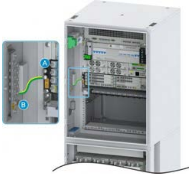
Şekil 15-38 ZXRAN V9200'ün PE Kablosunun Takılması
