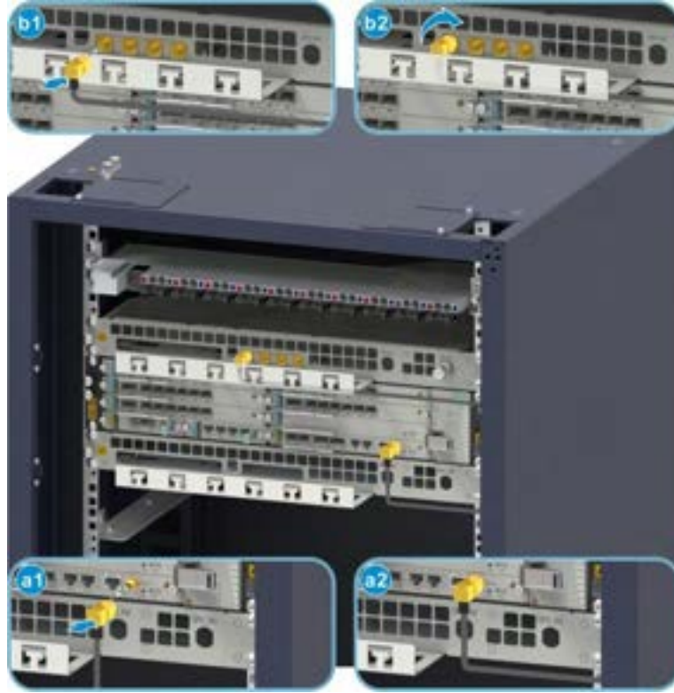
Şekil 13-22 GPS Jumper Kablosunun Bağlanması
