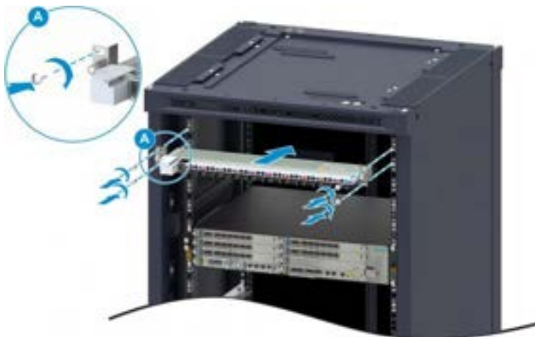
Şekil 12-17 VC9810 Kabinetine DCPD10B'nin Kurulumu
