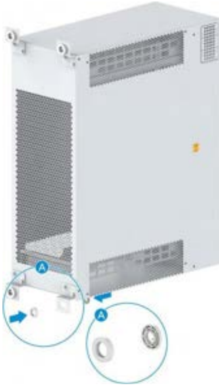
Şekil 10-11 Yalıtım Ara Parçalarının Takılması
