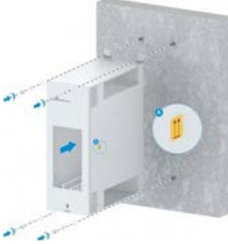
Şekil 10-12 VC9182 Kabinetinin Bağlantı Parçasının Monte Edilmesi
