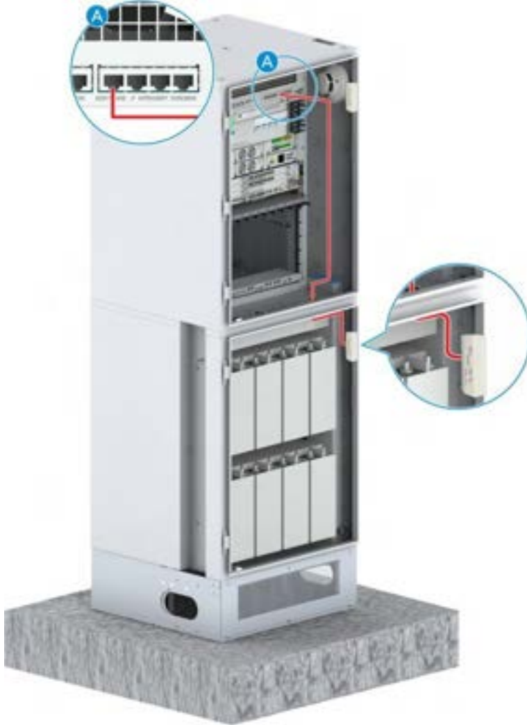
Şekil 15-59 PC9910A Kabinetinin, Kabinet Saldırı/İzinsiz Müdahale Sensör Kablosunun Yönlendirilmesi
