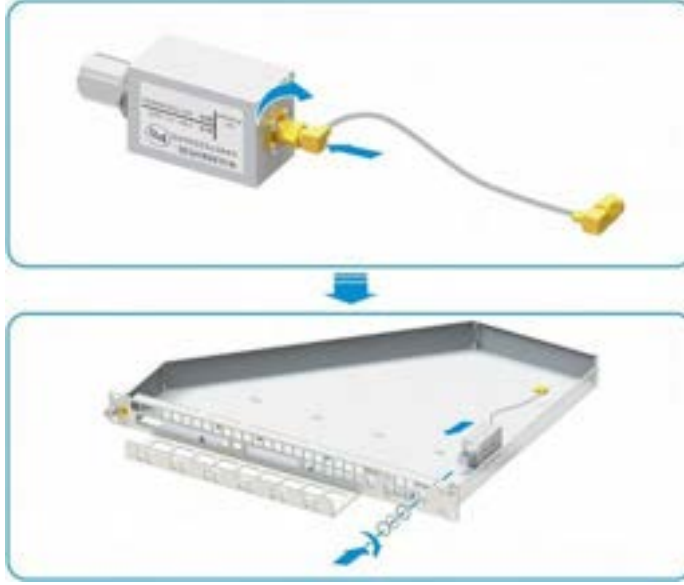
Şekil 13-15 Güç Bölme Biriminin Kurulumu (2)
