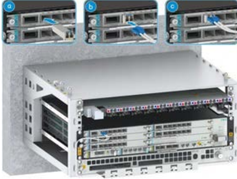
Şekil 9-22 VBP Kartına Optik Fiber Kablonun Bağlanması
