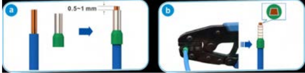
Şekil 12-34 Bir Tüp/Boru Şeklindeki Terminalin Sıkıştırılması
