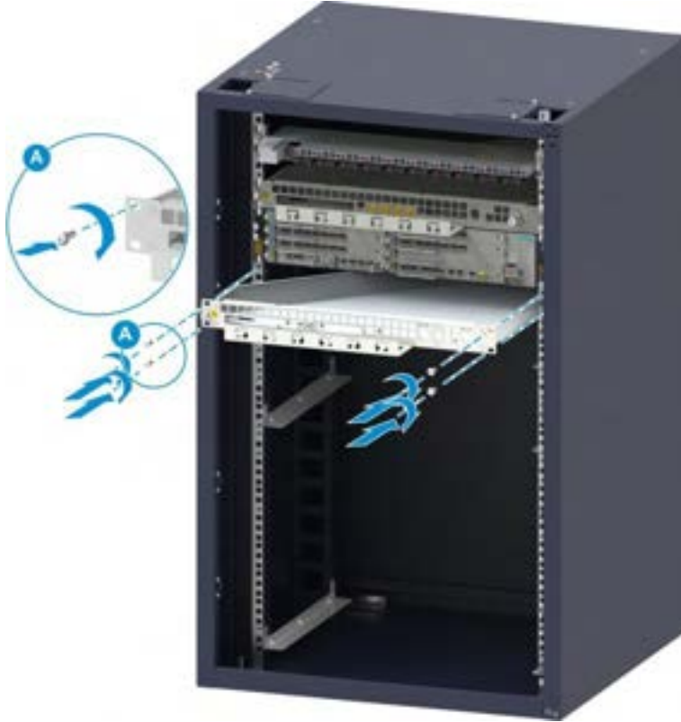
Şekil 13-17 VC9811 Kabinetinde Kablolama ve Havalandırma Biriminin Kurulumu
