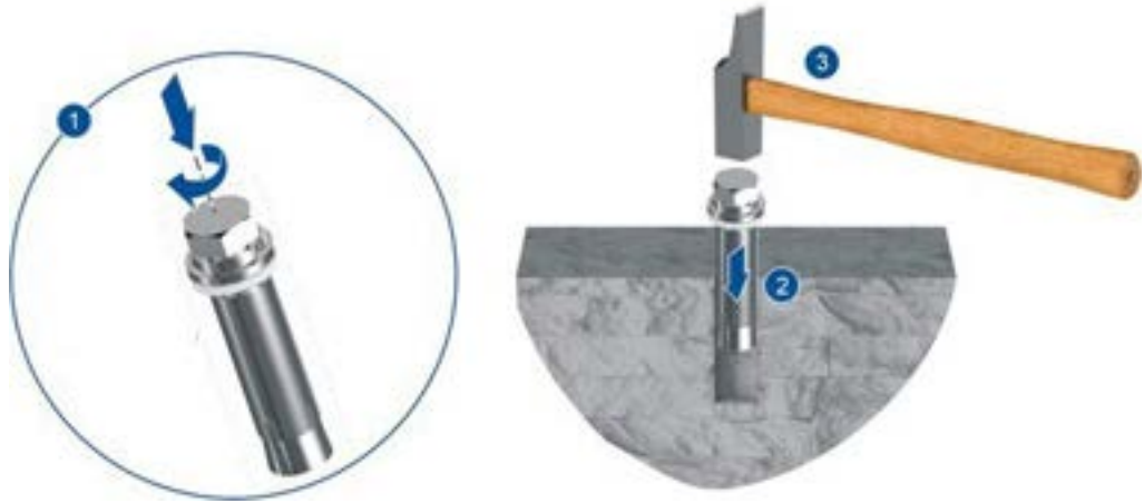
Şekil 15-5 Bir Dübelli Cıvatanın Takılması
