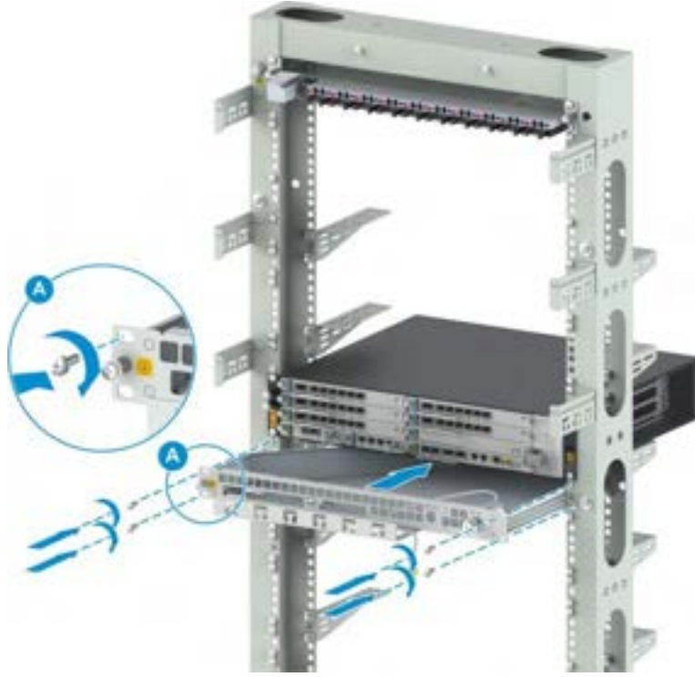
Şekil 17-11 Kablo ve Havalandırma Biriminin Ayaklı Çerçeve Sehpa Takılması
