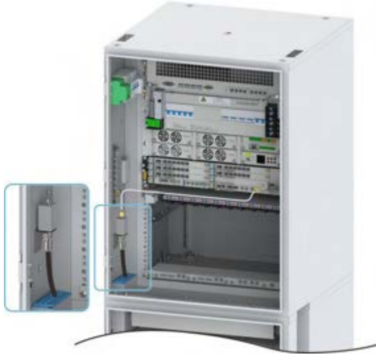
Şekil 15-44 GPS Feeder Kablosunun Bağlanması
