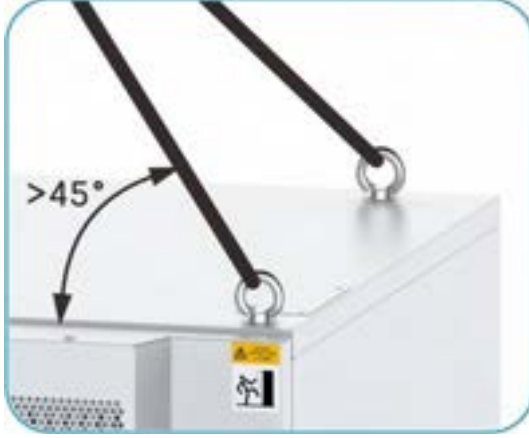
Şekil 15-2 Kabinet Taşıma/Kaldırma Gereklilikleri
