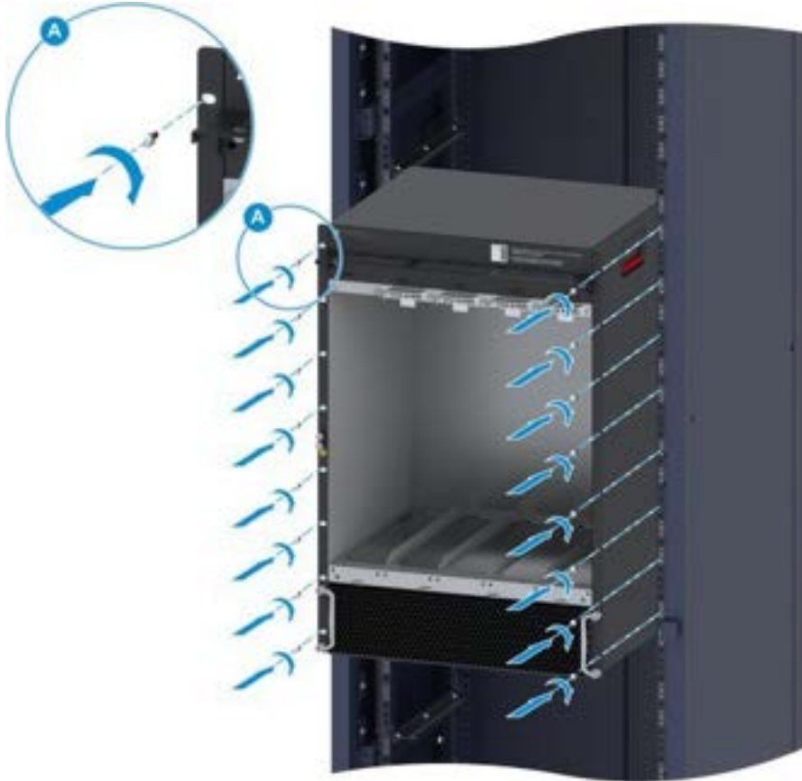
Şekil 11-3 19" Standart Kabinet içine VC9183'ün Kurulumu
