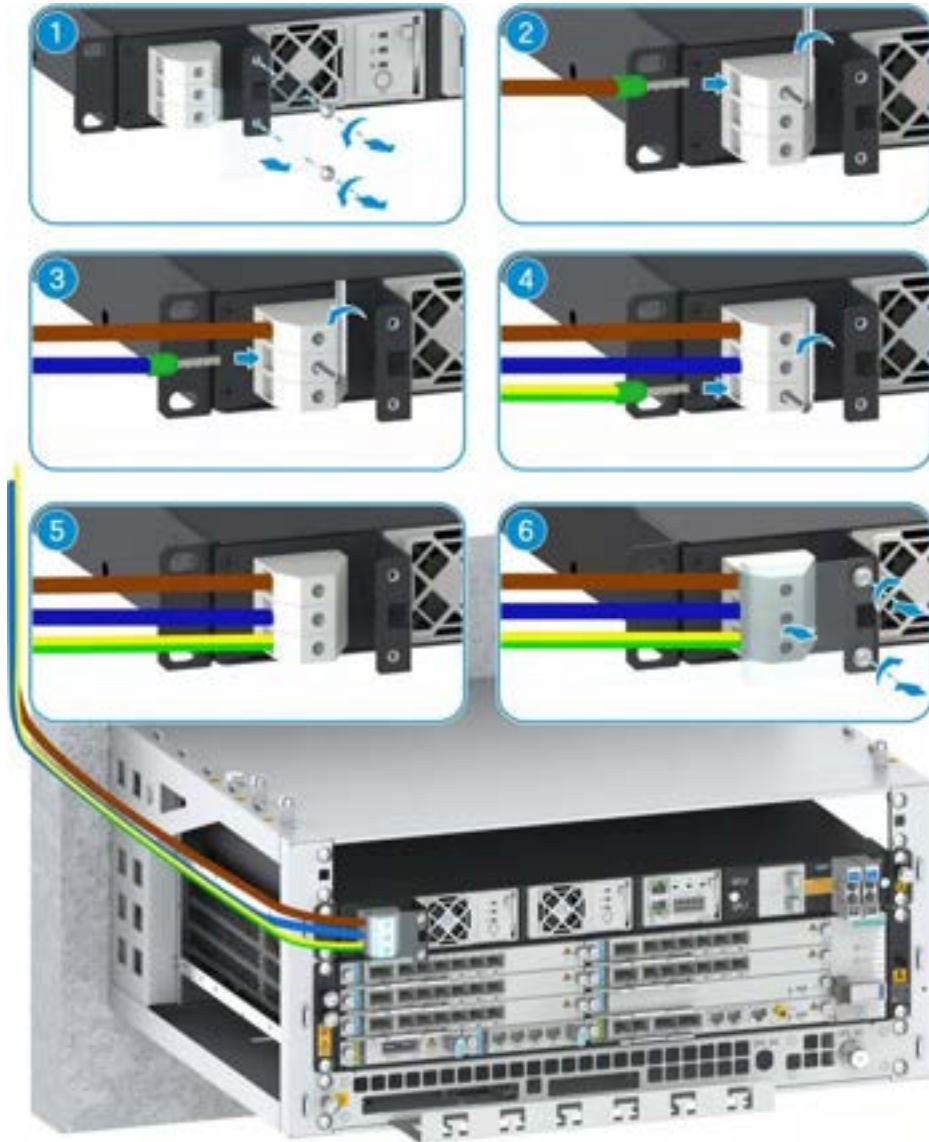
Şekil 10-46 B101'in Güç Kablosunun Takılması
