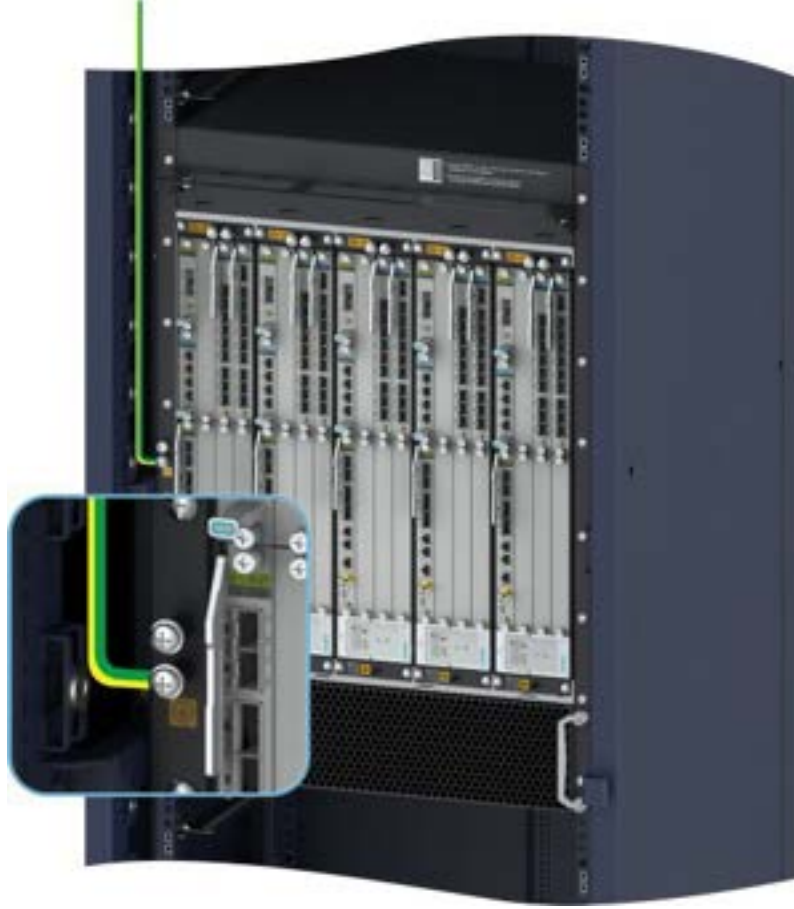
Şekil 11-9 PE Kablosunun Yönlendirilmesi
