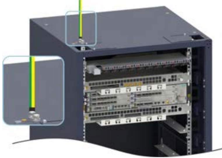
Şekil 13-21 PE Kablosunun Bağlanması
