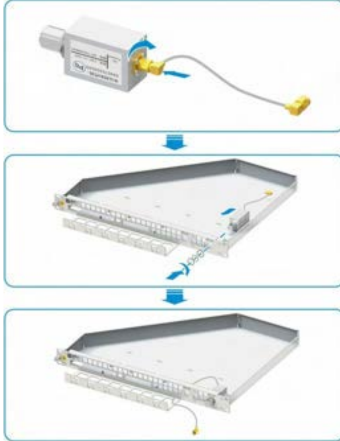
Şekil 18-16 GPS Yıldırım Tutucunun/Paratonerin Kurulumu
