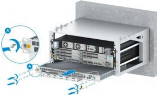
Şekil 9-14 VC9181 Kabinetine B101'in Kurulumu
