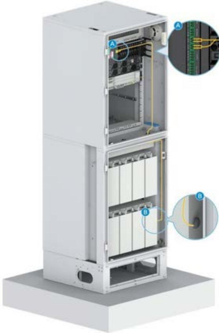
Şekil 15-82 PC9910A Kabinетinin Akü Sıcaklık İzleme Kablosunun Yönlendirilmesi
