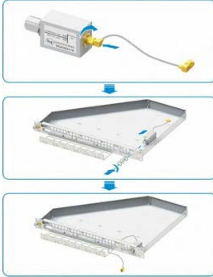
Şekil 17-10 GPS Yıldırım Tutucunun/Paratonerin Kurulumu
