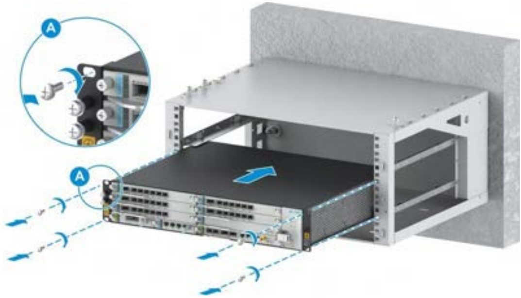
Şekil 9-8 VC9181 Kabinetine ZXRAN V9200'ün Kurulumu
