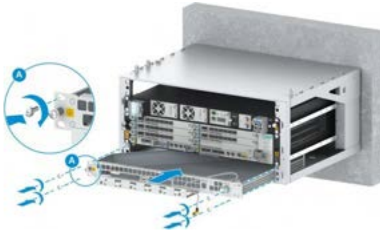
Şekil 9-16 VC9181 Kabinetinde Kablolama ve Havalandırma Biriminin Kurulumu
