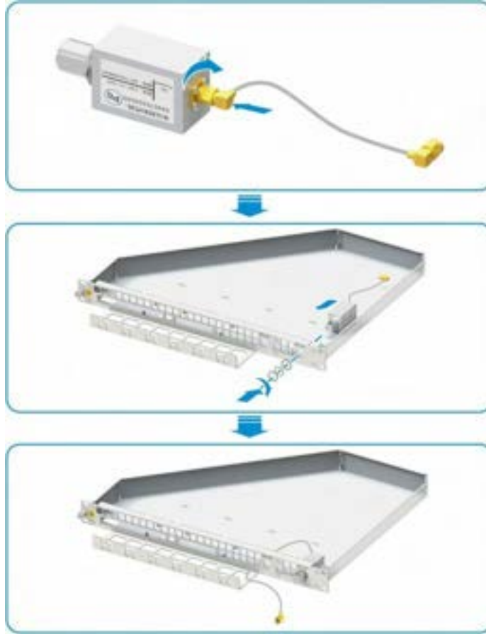
Şekil 9-15 GPS Yıldırım Tutucunun/Paratonerin Kurulumu
