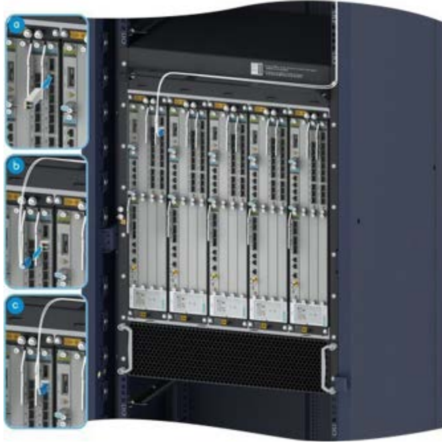
Şekil 11-11 VBP Kartına Optik Fiber Kablonun Bağlanması
