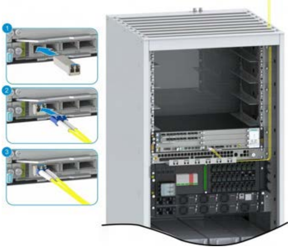
Şekil 14-22 VSW Kartına Optik Fiber Kablonun Bağlanması
