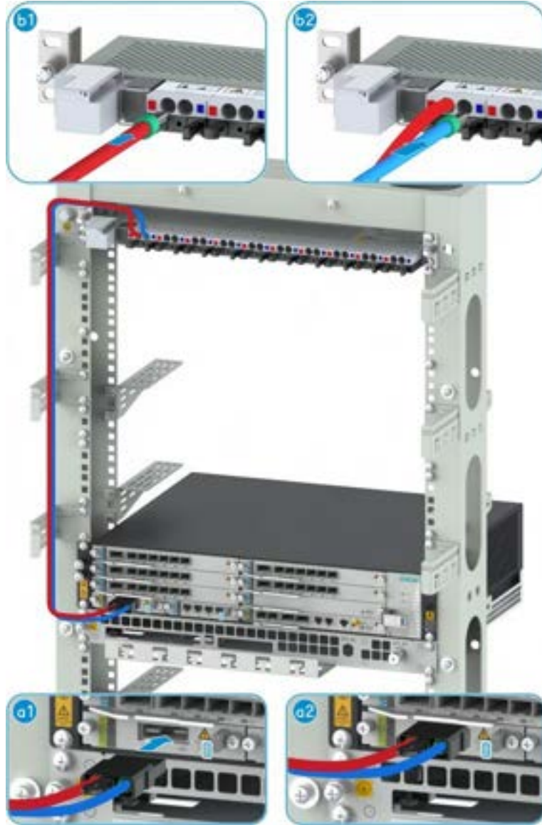
Şekil 17-21 Güç Kablosunun Takılması
