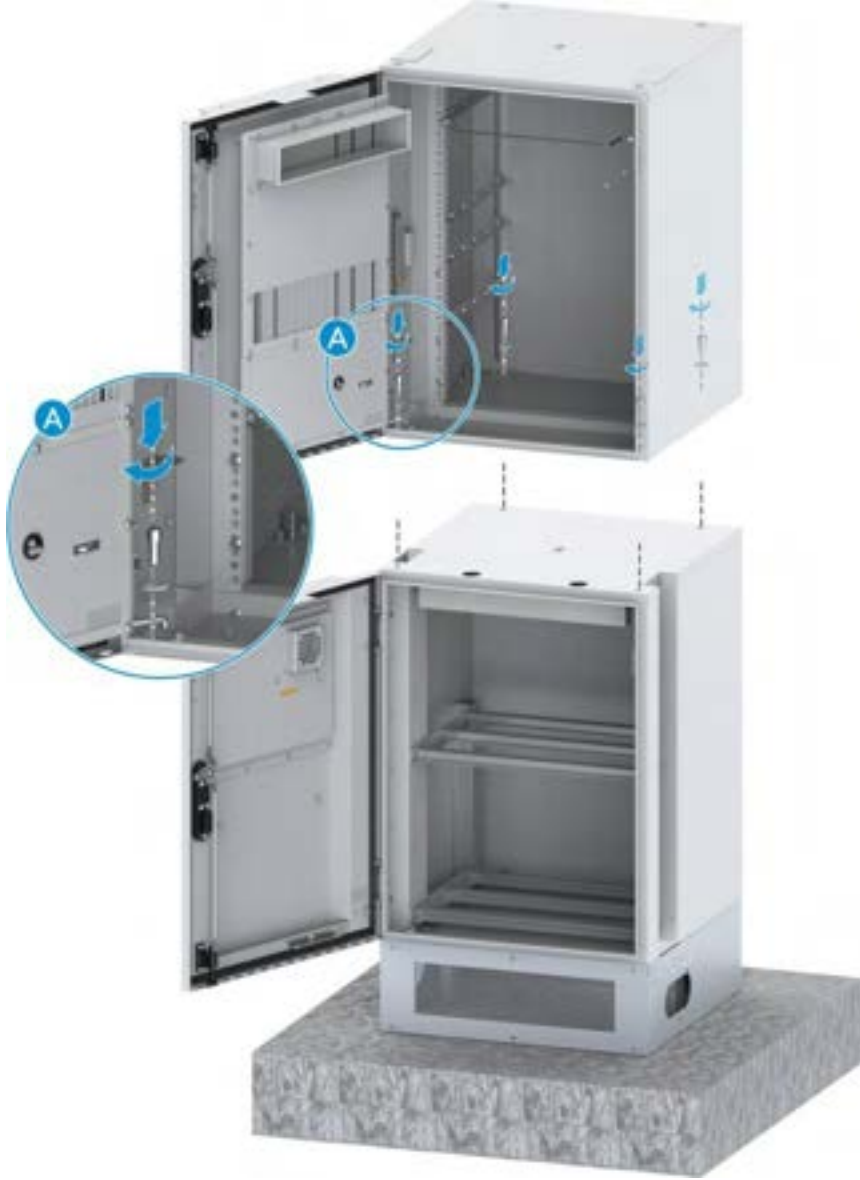
Şekil 16-10 Üst Kabinetin Alt Kabinete Sabitlenmesi
