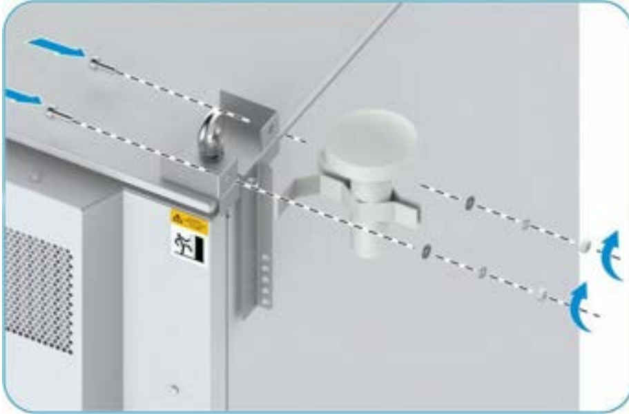
Şekil 15-27 GPS Antenin Sabitlenmesi
