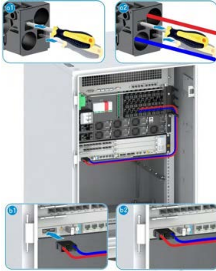
Şekil 16-44 Güç Kablosunun Takılması
