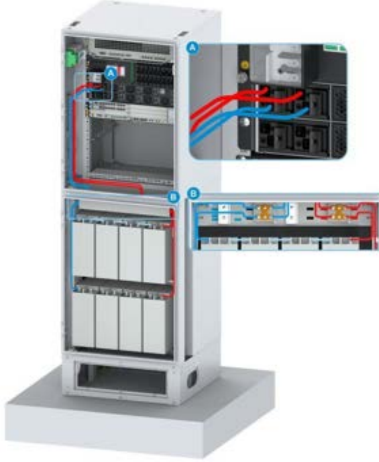
Şekil 15-81 PC9910A Kabinetinde DC Güç Kablosunun Yönlendirilmesi
