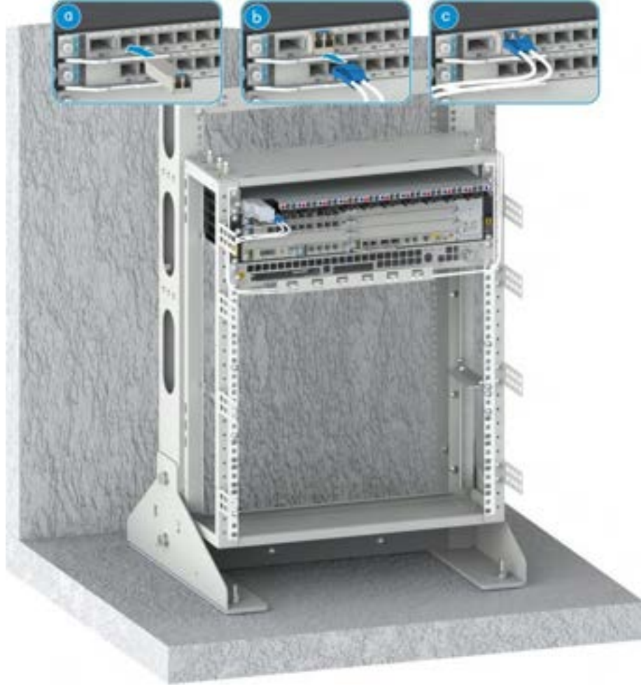
Şekil 18-24 VBP Kartına Optik Fiber Bağlanması
