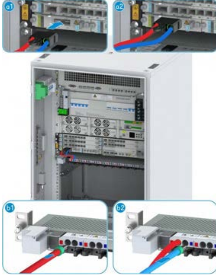
Şekil 15-50 Güç Kablosunun Takılması
