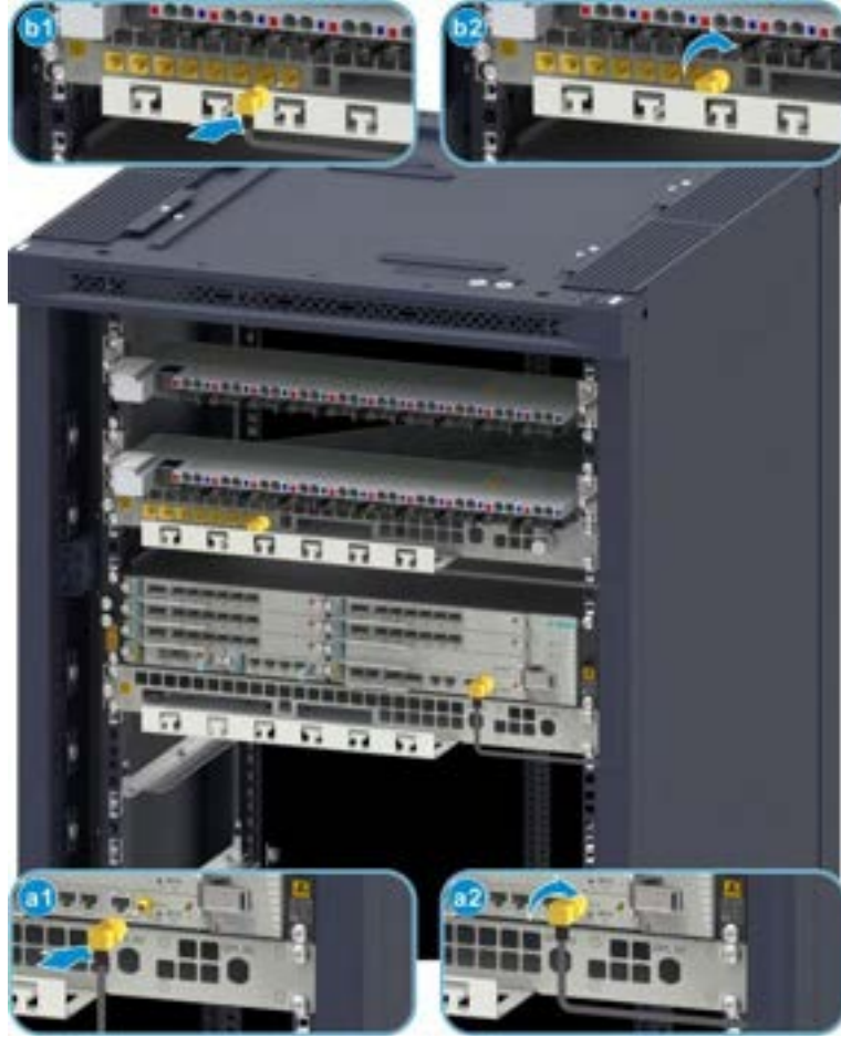
Şekil 12-26 GPS Jumper Kablosunun Bağlanması
