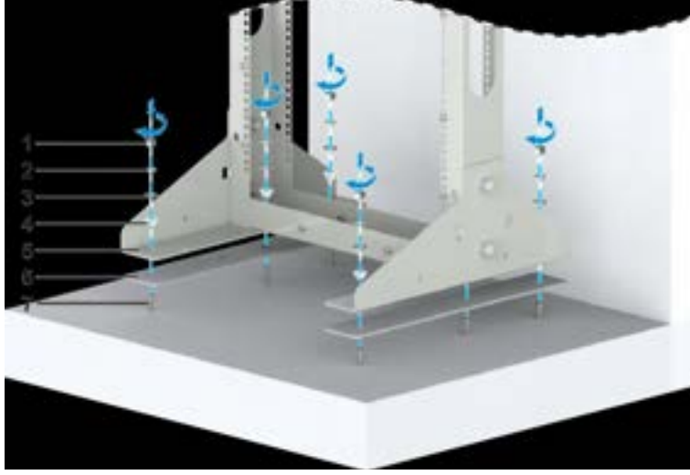
Şekil 18-8 L-Şekilli Çatının Sabitlenmesi
