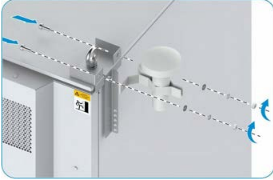
Şekil 16-23 GPS Antenin Sabitlenmesi
