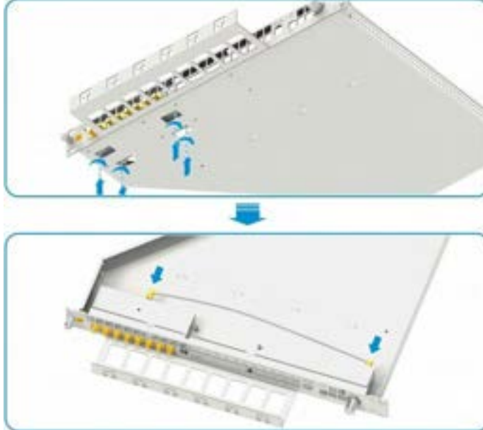
Şekil 12-19 Güç Bölme Biriminin Kurulumu (2)
