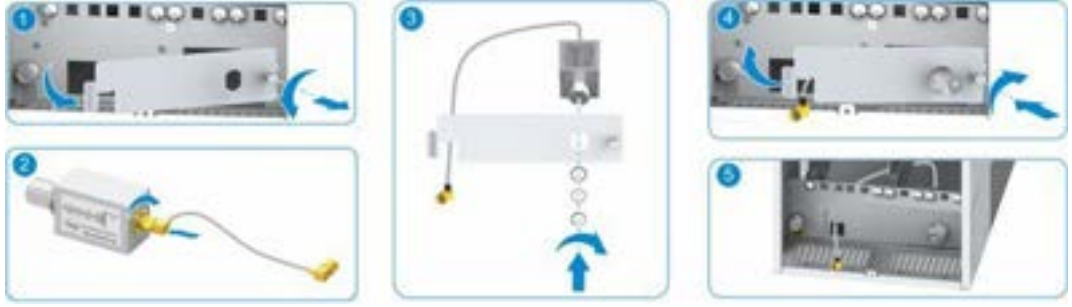
Şekil 10-16 GPS Yıldırım Tutucunun/Paratonerin Kurulumu
