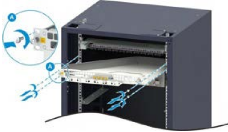
Şekil 13-16 Güç Bölme Biriminin Kurulumu
