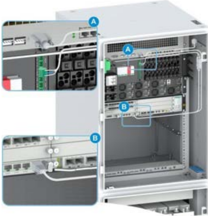
Şekil 15-79 V9200'ün İzleme Kablosunun Takılması
