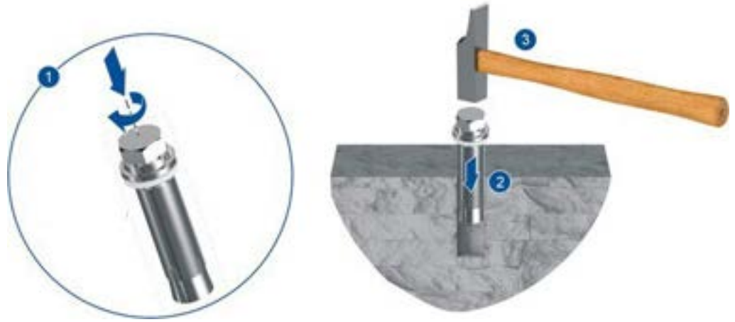
Şekil 12-10 Bir Dübelli Cıvatanın Takılması
