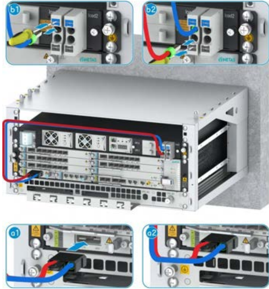
Şekil 9-37 Güç Kablosunun Takılması
