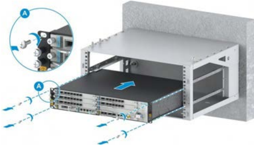
Şekil 9-13 VC9181 Kabinetine ZX-RAN V9200'ün Kurulumu
