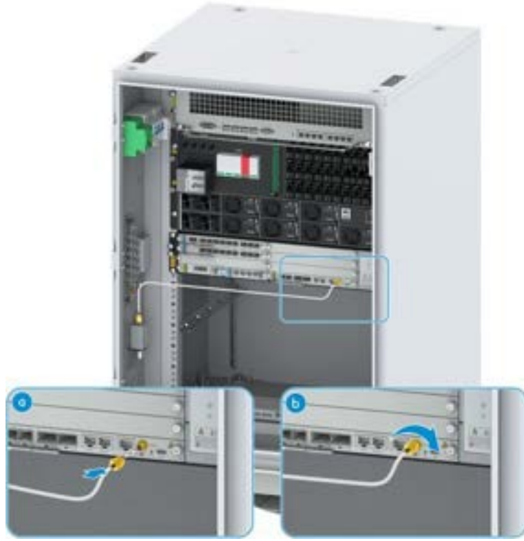
Şekil 15-72 GPS Jumper Kablosunun Bağlanması
