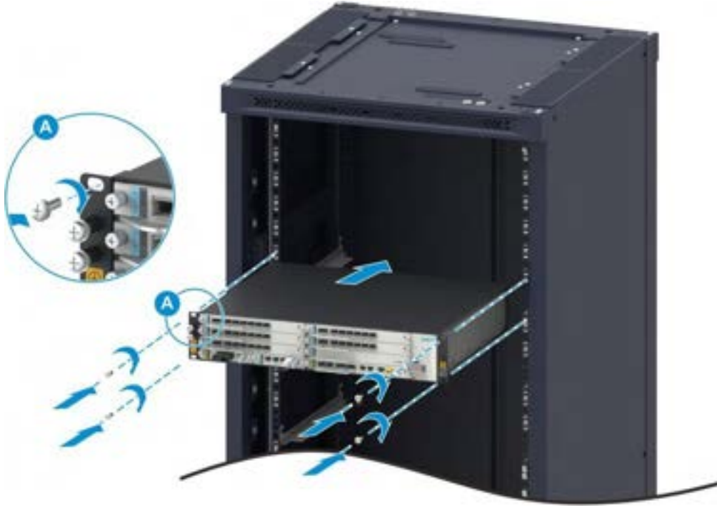
Şekil 12-16 VC9810 Kabinetine ZXRAN V9200'ün Kurulumu
