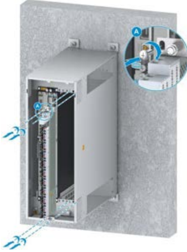
Şekil 10-18 VC9182 Kabinetine DCPD10B'nin Kurulumu
