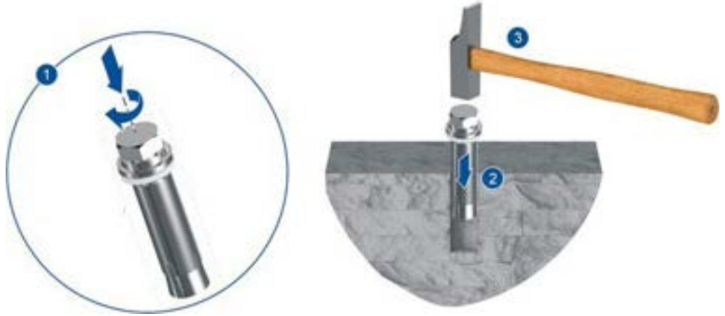
Őekil 13-8 Bir Dbelli Cıvatanın Takılması
