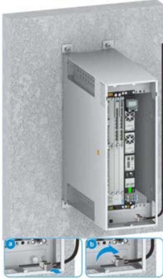
Şekil 10-40 GPS Feeder Kablosunun Bağlanması
