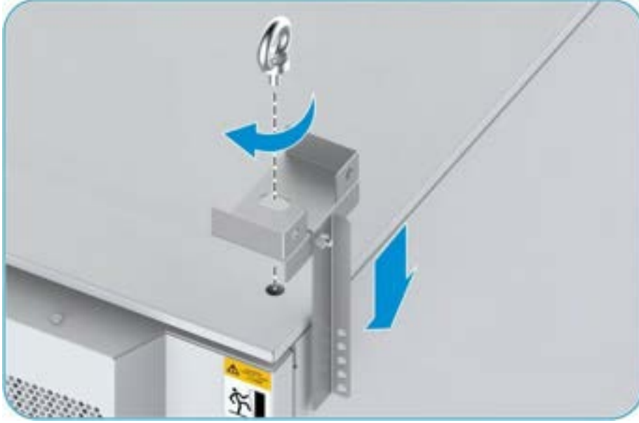
Şekil 15-26 Kabinetin Üstüne Aksesuarların Sabitlenmesi
