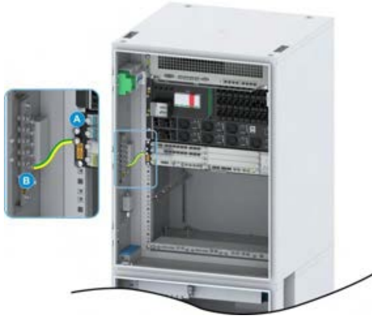
Şekil 16-34 ZXRAN V9200'ün PE Kablosunun Takılması
