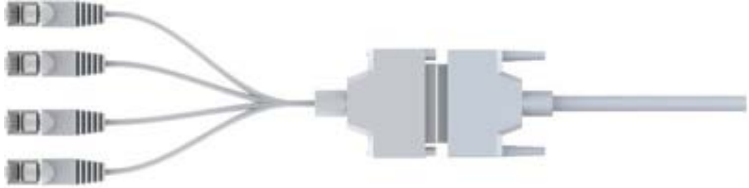
Şekil 4-10 VEMc1w Kartının Kuru Kontak Kablosu ve DB44 Kablosu Arasındaki Bağlantı
