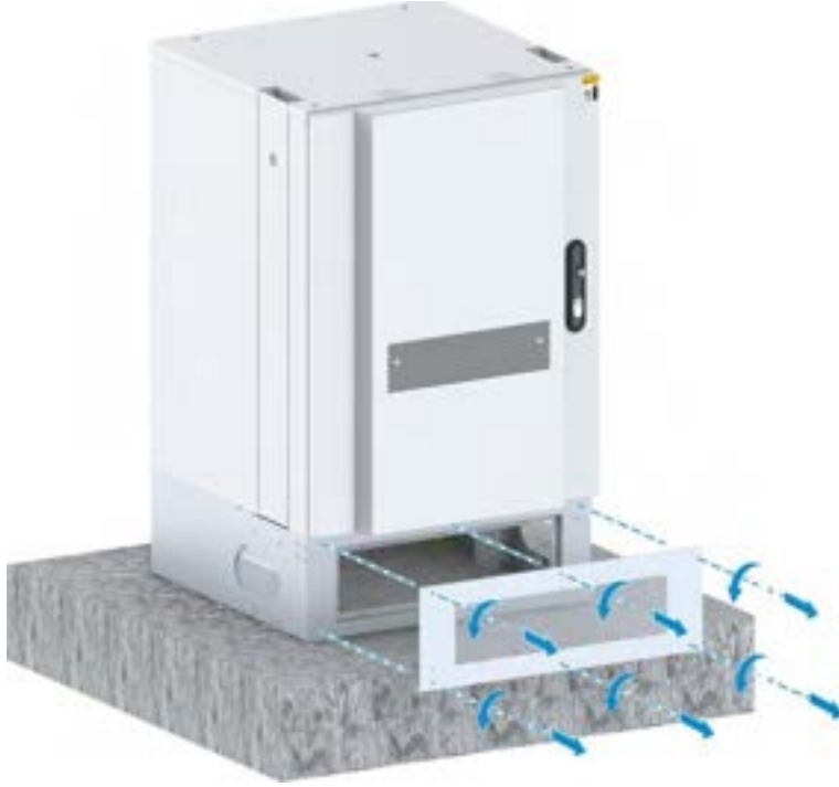
Şekil 16-9 Bazanın Ön Panelinin Sökülmesi.
