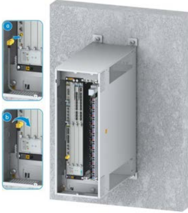
Şekil 10-27 GPS Jumper Kablosunun Bağlanması
