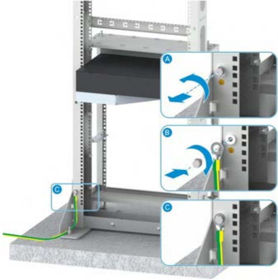
Şekil 18-20 PE Kablosunun Bağlanması
