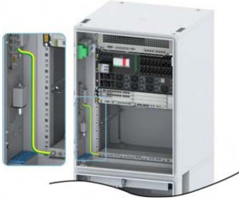
Şekil 16-36 LPU2'nin PE Kablosunun Takılması
