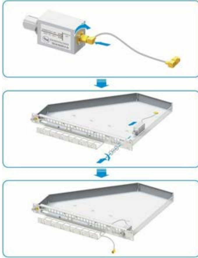
Şekil 14-7 GPS Yıldırım Tutucunun/Paratonerin Kurulumu
