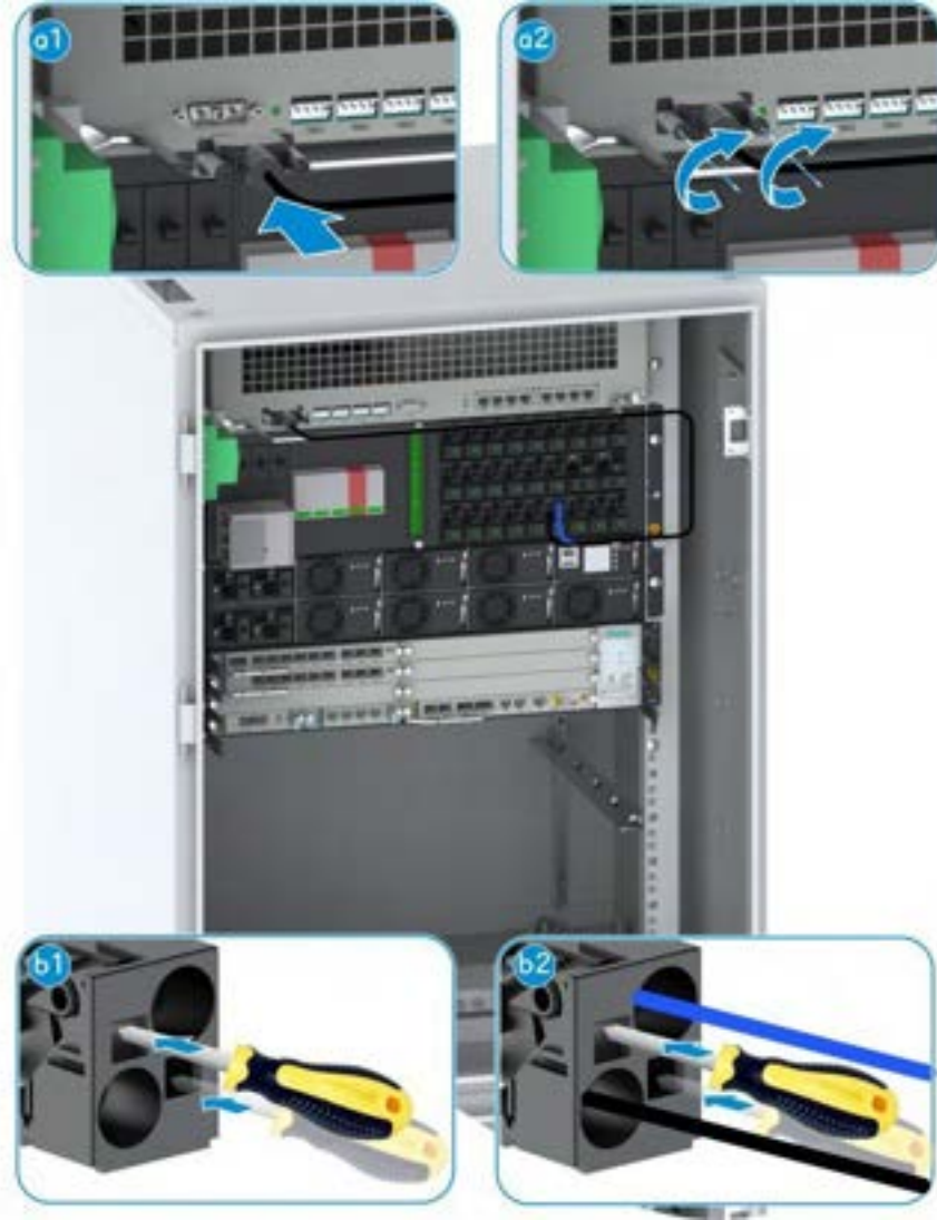
PC9910A Kabinetinin Fan Güç Kablosunun Takılması
