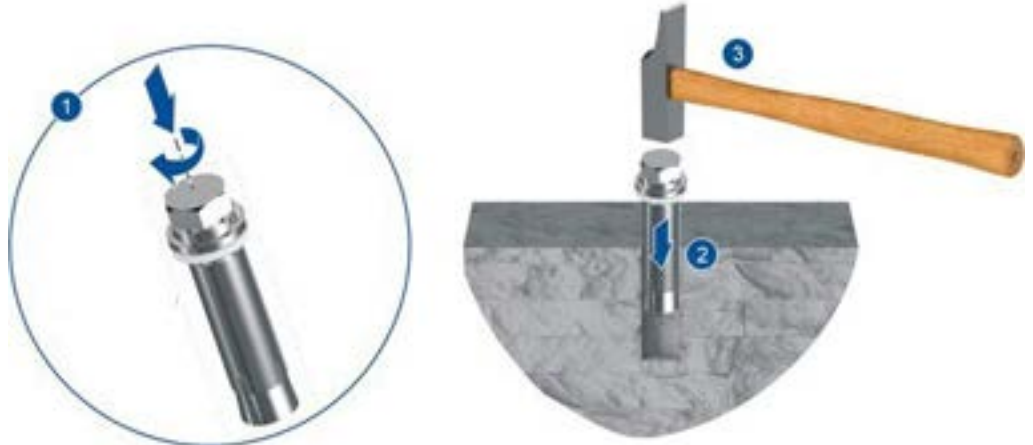
Şekil 13-3 Bir Dbelli Cıvatanın Takılması
