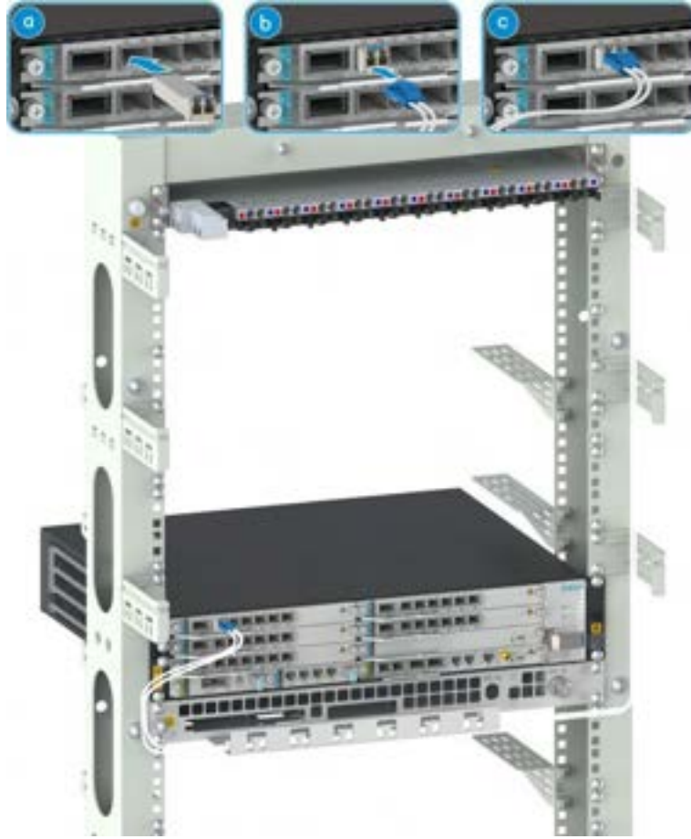
Şekil 17-17 VBP Kartına Optik Fiber Kablonun Bağlanması
