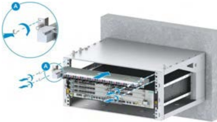
Şekil 9-9 VC9181 Kabinetine DCPD10B'nin Kurulumu
