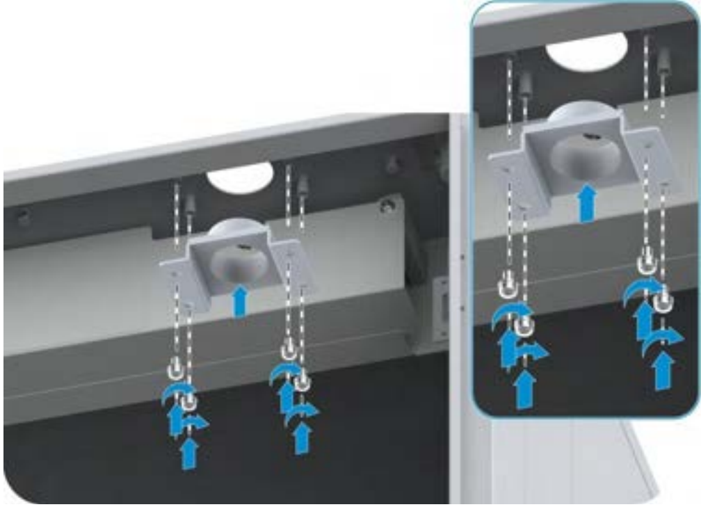
Şekil 15-15 Alt Kabinete Kablo Deliği Düzenliğinin Sabitlenmesi
