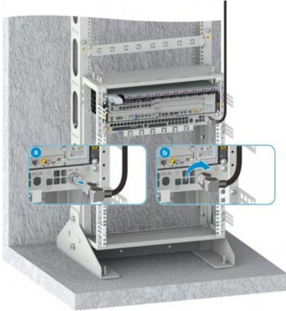
Şekil 18-23 GPS Feeder Kablosunun Bağlanması
