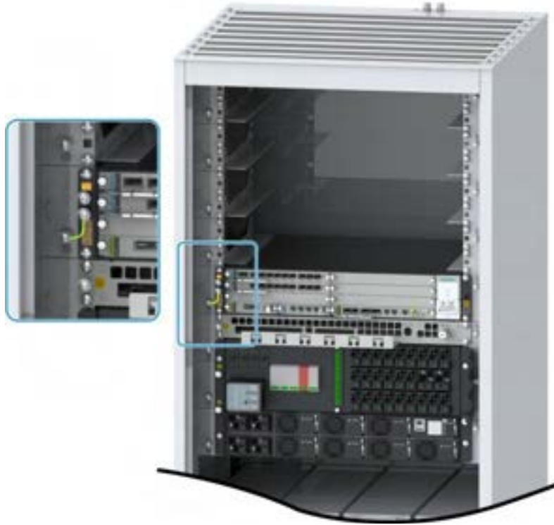
Şekil 14-16 ZX-RAN V9200'ün PE Kablosunun Montajı
