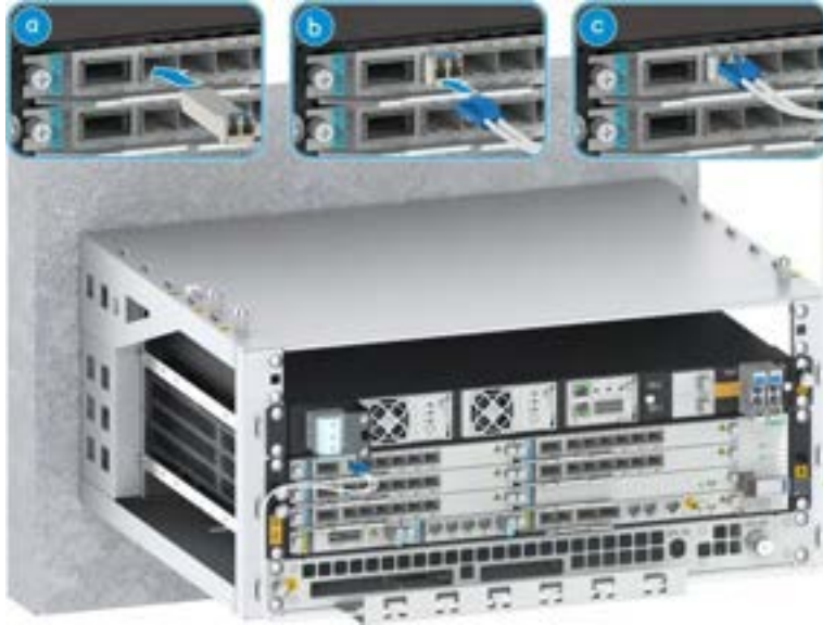
Şekil 9-34 VBP Kartına Optik Fiber Kablonun Bağlanması
