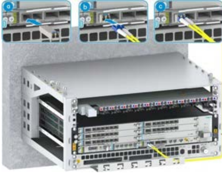
Şekil 9-23 VSW Kartına Optik Fiber Kablonun Bağlanması
