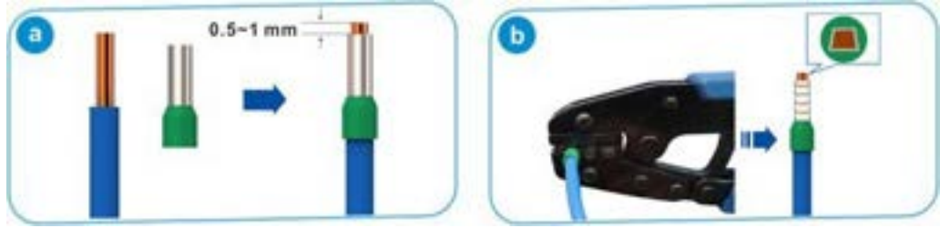
Şekil 10-45 Bir Tüp/Boru Şeklindeki Terminalin Sıkıştırılması
