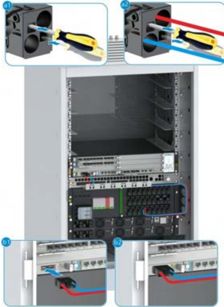
Şekil 14-23 Güç Kablosunun Takılması
