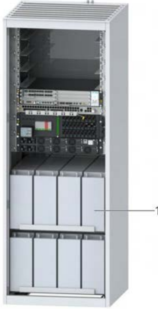
Şekil 14-10 Kabinet içinde Akü Yerleşimi
