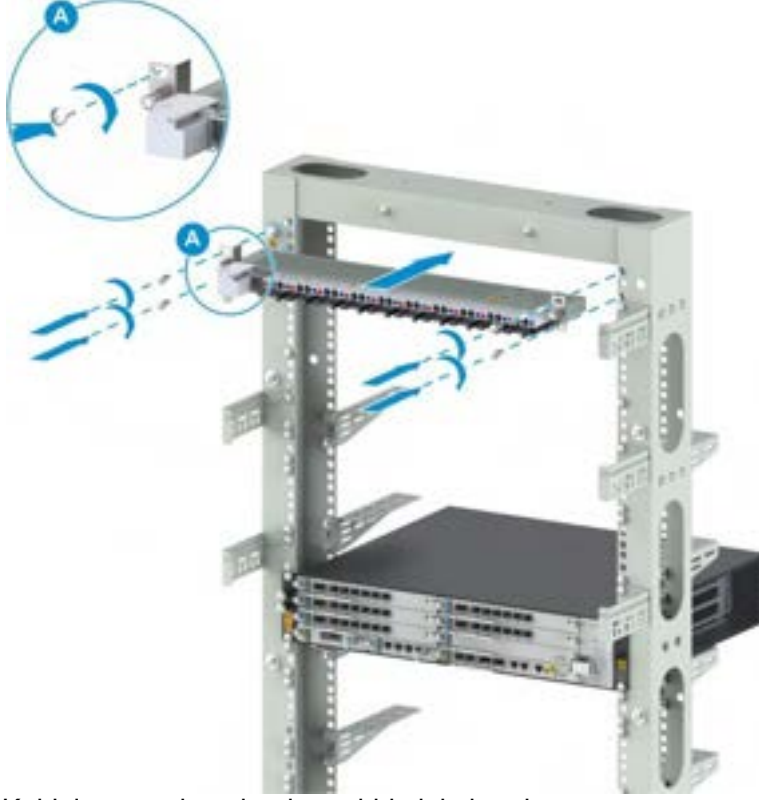
Şekil 17-9 Ayaklı Çerçeve Sehpa Üzerine DCPD10B'nin Takılması
