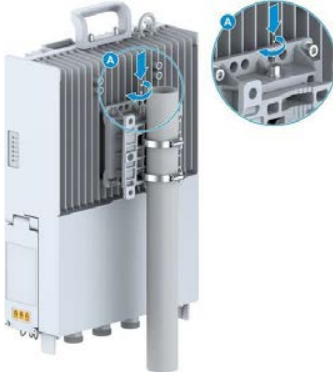
Şekil 4-34 Kilitleme Vidasının Sıkıştırılması
