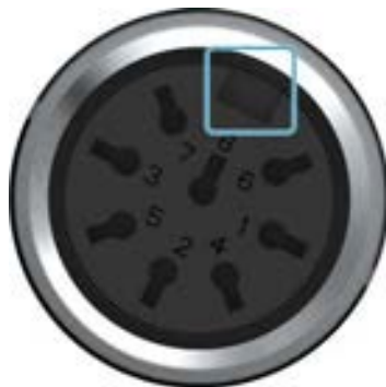
Şekil 10-8 Sızdırmazlık Halkasının Kontrol Edilmesi
