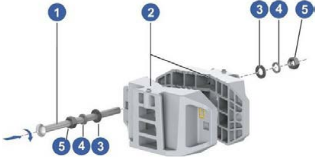
Şekil 8-21 Direk Montaj Düzenine Kurulumu
