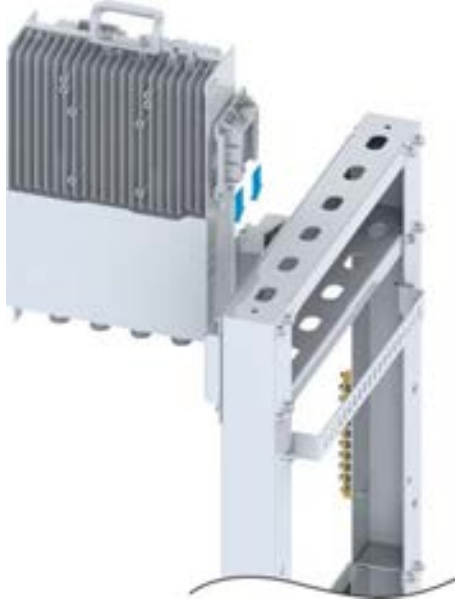
Şekil 8-48 L-Şekilli Destek Üzerine RRU'nun Kurulumu
