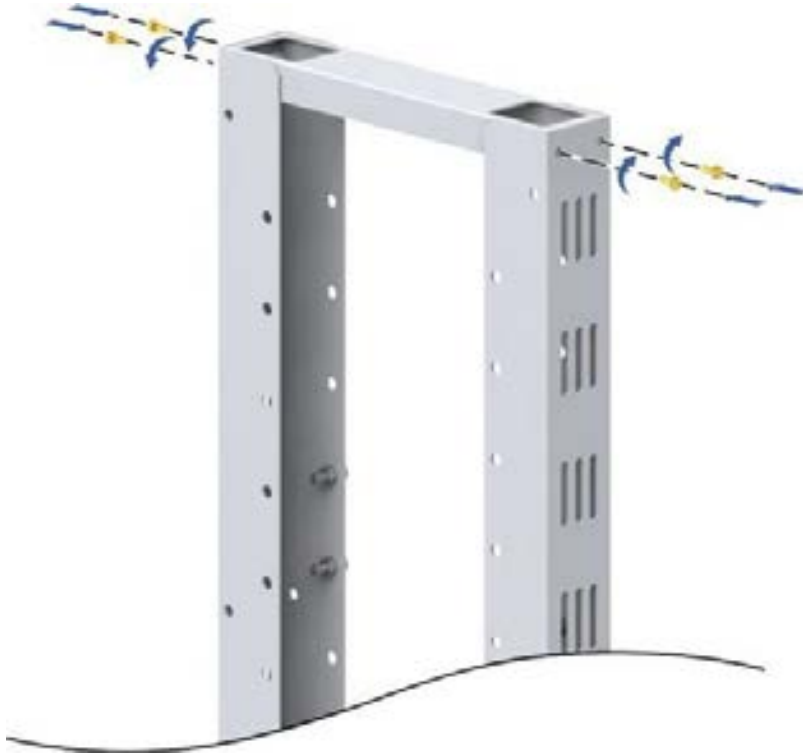
Şekil 15-16 Direk ve Üst Kirişin Sıkıştırılması
