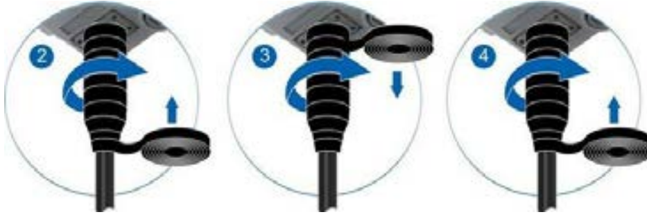
Şekil 15-9 Su Geçirmez/Anti-Ultraviyole Bandın Sarılması
