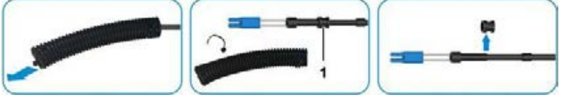
Şekil 10-19 Oluklu Boru ve Sürgünün Sökülmesi
