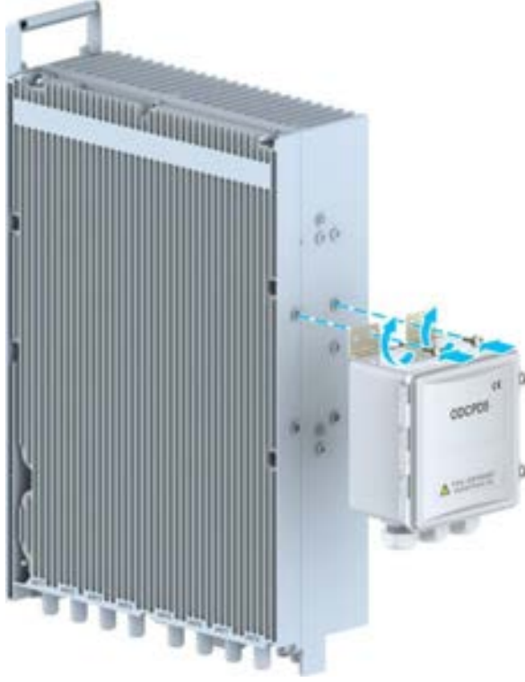
Şekil 9-15 Bir RRU'ya ODCPD5'in Kurulumu (2)
