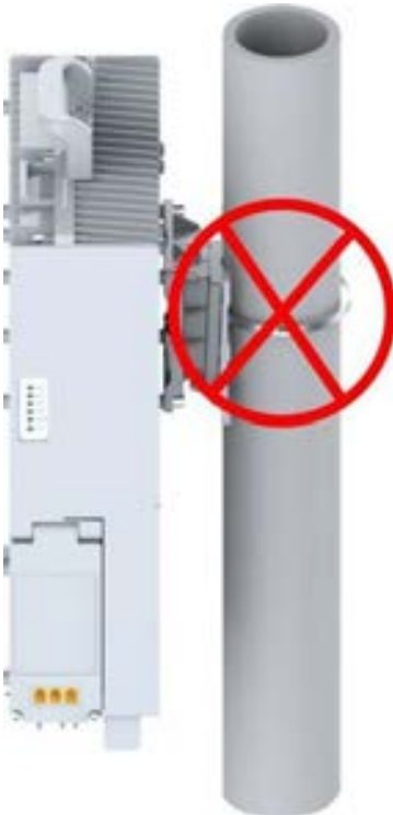
Şekil 7-17 Sadece Bir Kelepçe Monte Etmeyin
