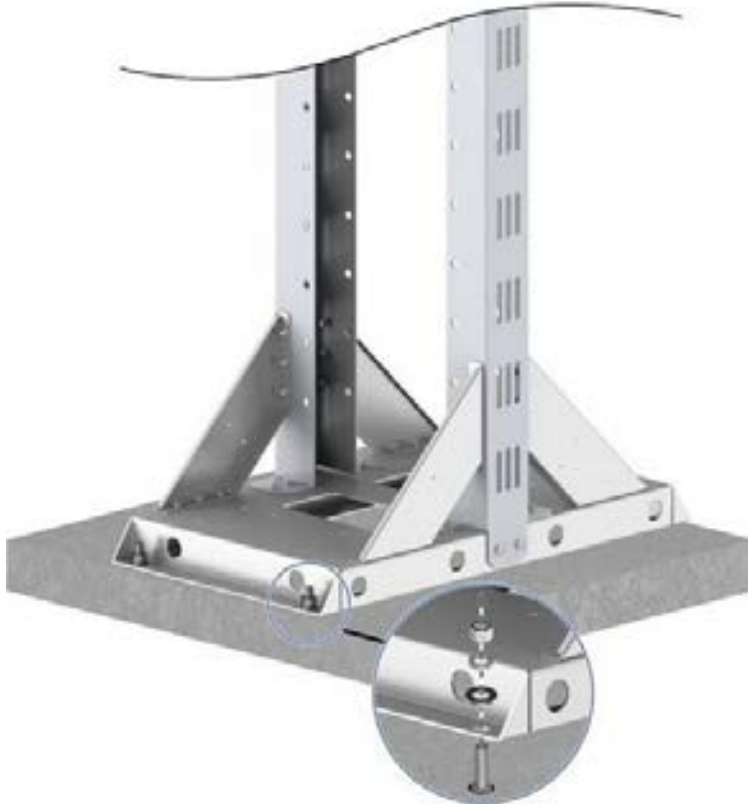
Şekil 15-19 Ayaklı Çerçeve Sehpanın Bir Beton Taban Plakasına Sabitlenmesi
