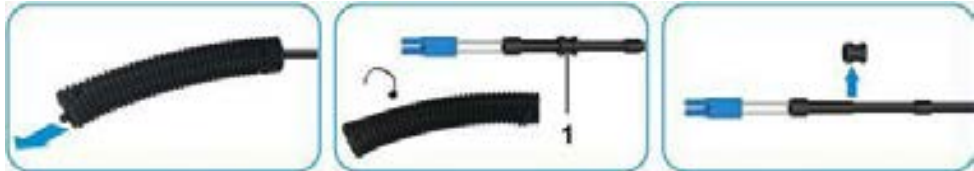
Şekil 9-15 Oluklu Boru ve Sürgünün Sökülmesi
