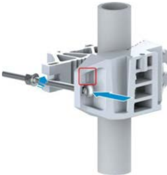
Şekil 8-12 Direk Montaj Düzeneğinin Kurulumu - 1
