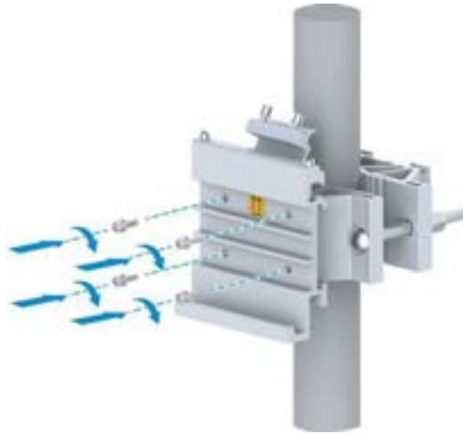
Şekil 8-52 Destek Oturağın Sabitlenmesi
