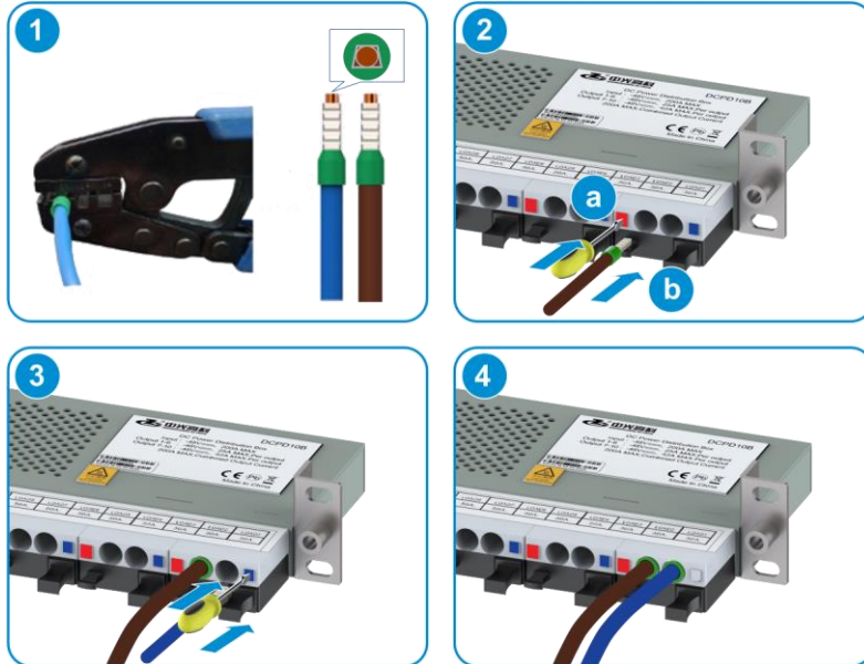
Şekil 9-26 Güç Kablosunun DCPD'ye Bağlanması
