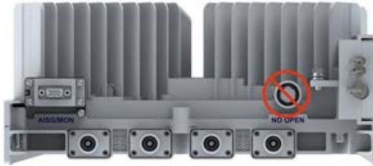
Şekil 7-13 Hava Geçirmez Tapanın Açılması Yasaktır
