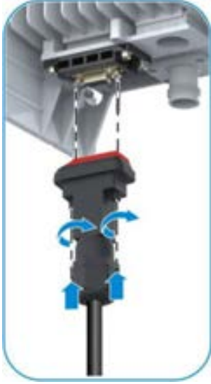
Şekil 9-13 MON Kablosunun Takılması
