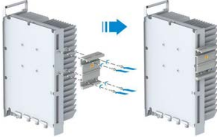
Şekil 8-59 Bayrak Gibi Montaj Bağlantı Parçasının R9224E'ye Sabitlenmesi
