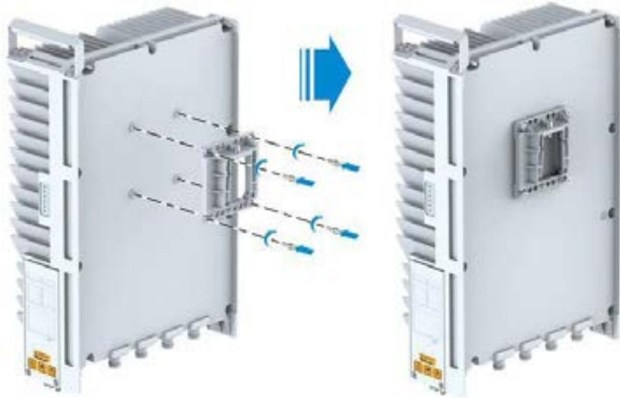
Şekil 7-9 Arka Tarafa Bağlantı Parçasının Monte Edilmesi
