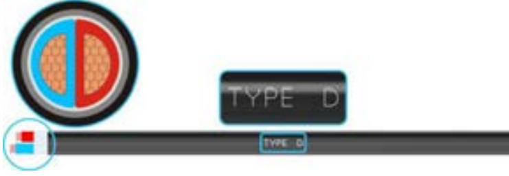
Şekil 3-9 D-şekilli tel DC güç kablosu
