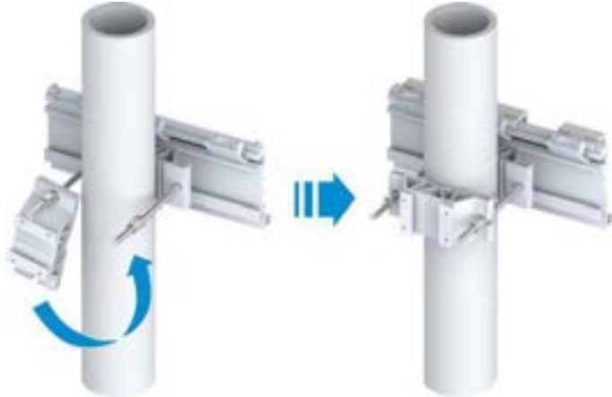
Şekil 8-58 Direk Montaj Düzeneğinin Sabitlenmesi
