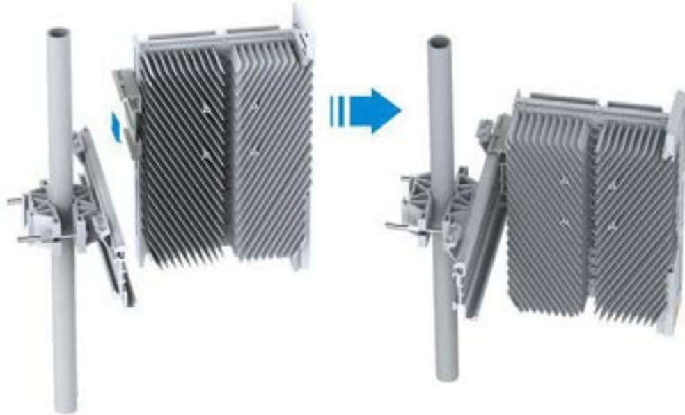
Şekil 8-60 ZXRAN R9224E'nin Montajı
