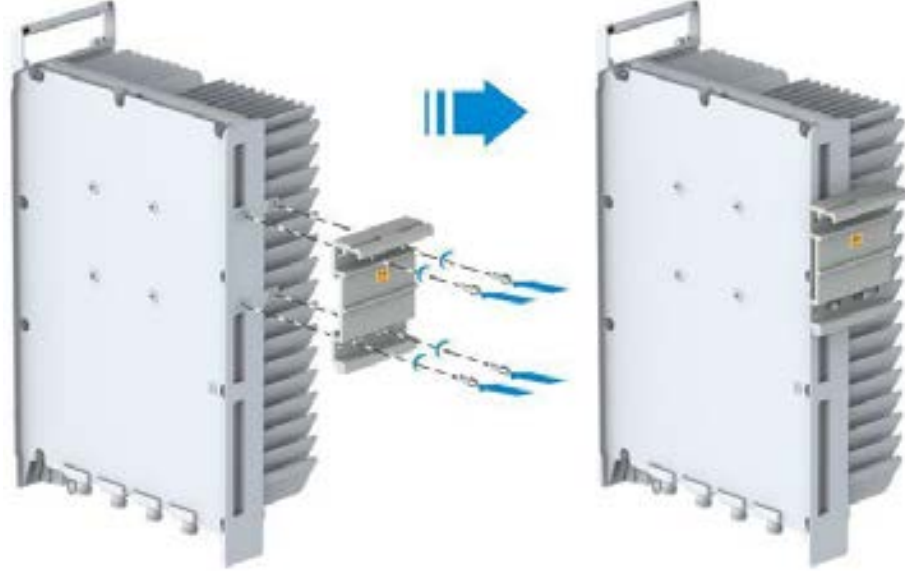
Şekil 8-34 Bayrak Gibi Montaj Bağlantı Parçasının Kurulumu
