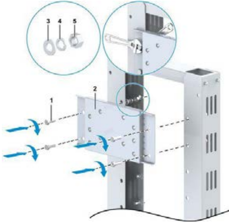
Şekil 8-38 Adaptör Plakanın/Levhanın Kurulumu
