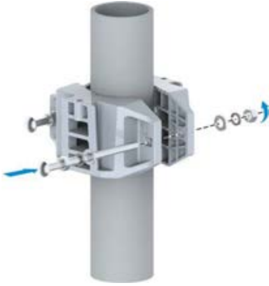
Şekil 8-17 Direk Montaj Düzeneğinin Kurulumu - 1
