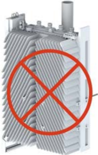
Şekil 7-14 RRU'nun Baş Aşağı Kurulumu Yasaktır
