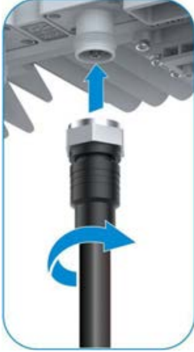
Şekil 9-4 Anten Besleme Kablosunun Kurulumu
