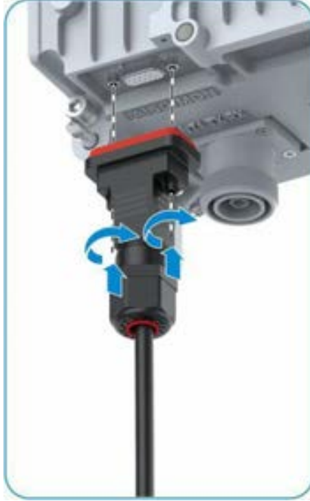
Şekil 11-18 Bir İzleme Arayüzü Kablosunun Kurulumu
