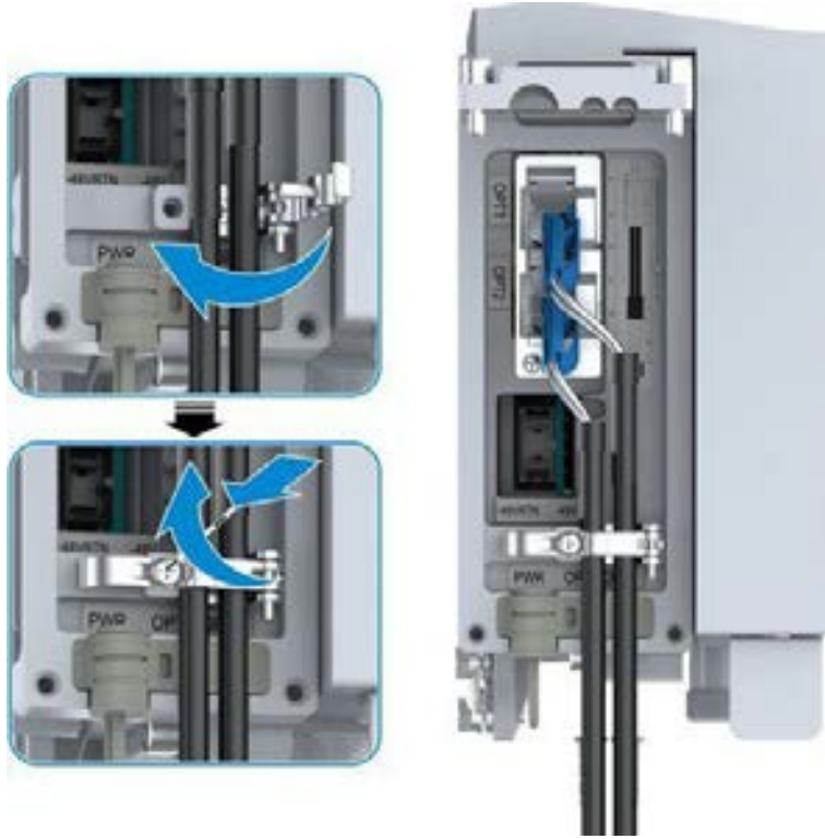
Şekil 11-9 Kullanılmayan Optik Fiber Kablonun Tekrar Kendi Orijinal Pozisyonuna Döndürülmesi için Su Geçirmez Lastik Tapanın Yerleştirilmesi
