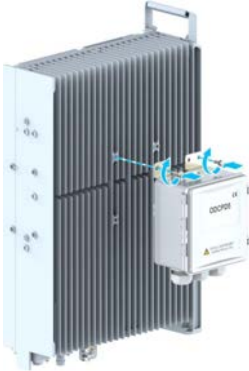
Şekil 10-14 Bir RRU'ya ODCPD5'in Kurulumu (1)
