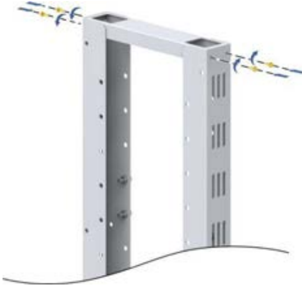
Şekil 16-16 Direk ve Üst Kirişin Sıkıştırılması
