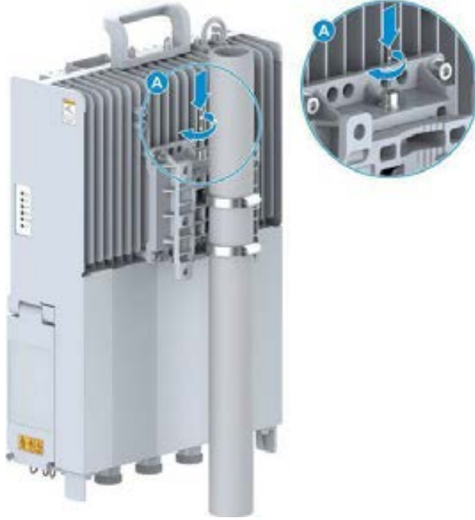
Şekil 9-34 Kilitleme Vidasının Sıkıştırılması
