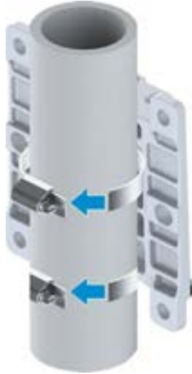
Şekil 9-31 Direk Kelepçelerinin Takılması (1)
