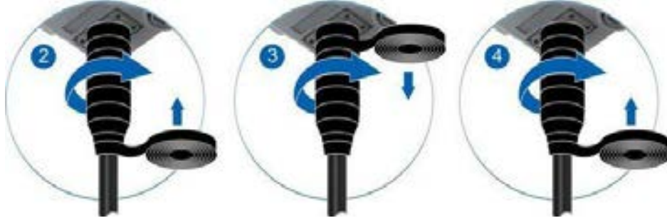
Şekil 16-9 Su Geçirmez/Anti-Ultraviyole Bandın Sarılması
