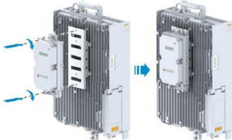
Şekil 10-4 ODCPD1 Bağlantı Kutusunun Bağlanması
