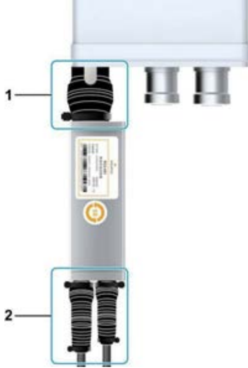
Şekil 16-14 RCU'nun AISG Arayüzlerinin Su Geçirmez Hale Getirilmesi
