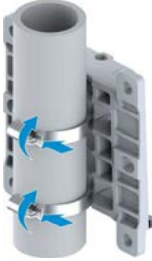
Şekil 9-32 Direk Keleççelerinin Takılması (2)
