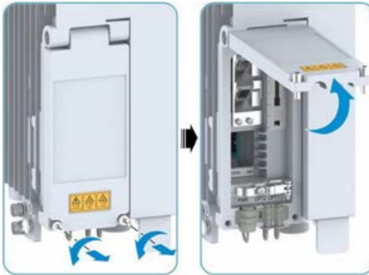
Şekil 11-4 Bakım Penceresinin Açılması
