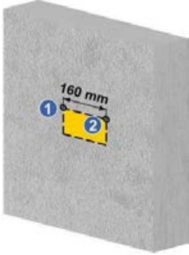
Şekil 9-35 Dübelli Cıvataların Montaj Pozisyonları
