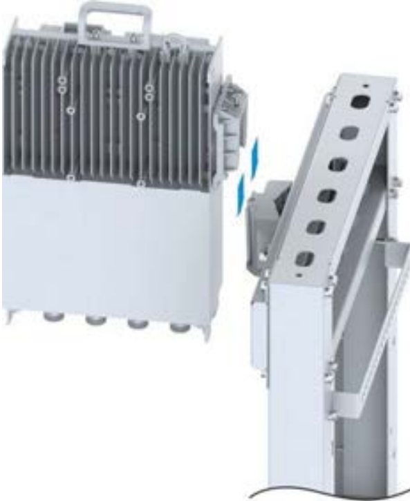
Şekil 9-47 L-Şekilli Destek Üzerine RRU'nun Kurulumu
