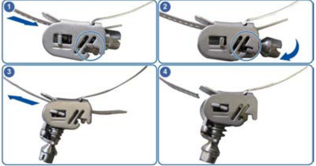
Şekil 10-16 Kelepçenin Çözülmesi
