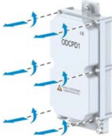
Şekil 10-5 ODCPD1'in Kapak Plakasının Açılması
