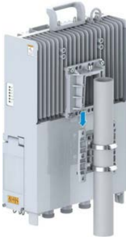
Şekil 9-33 ZXSDR R8854'ün Monte Edilmesi
