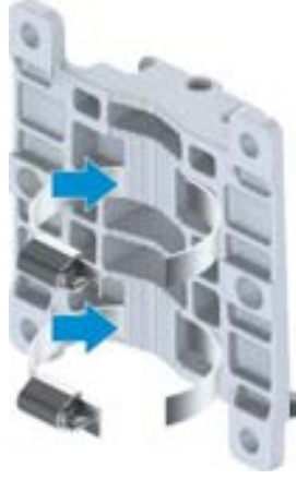
Şekil 9-30 Direk Kelepçelerinin Sabitleme Klipsine Takılması
