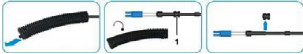
Şekil 11-6 Oluklu Boru ve Sürgünün Sökülmesi
