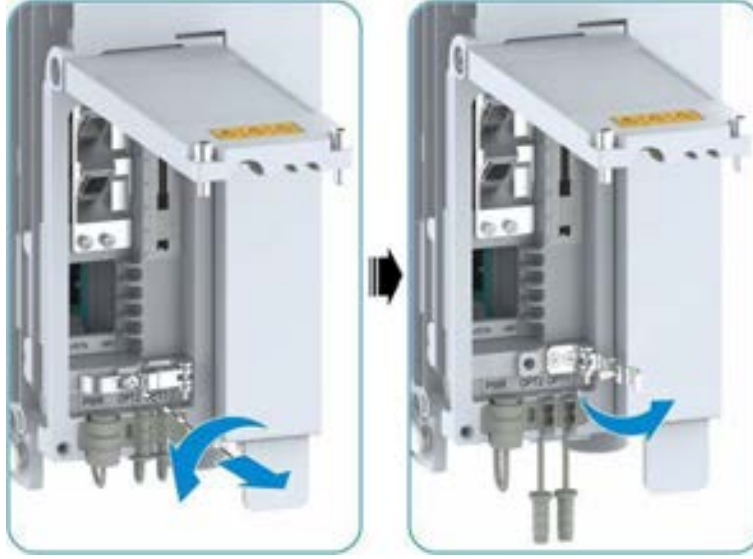
Şekil 11-5 Sıkıştırma Klipsinin Açılması
