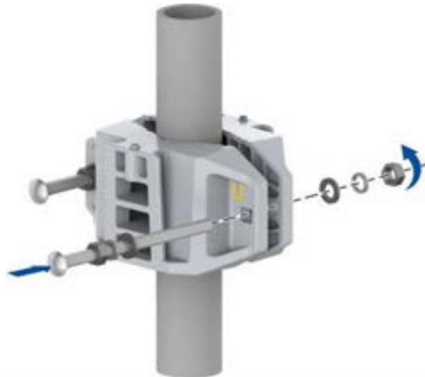
Şekil 4-22 Direk Montaj Düzeneğinin Kurulumu (1)
