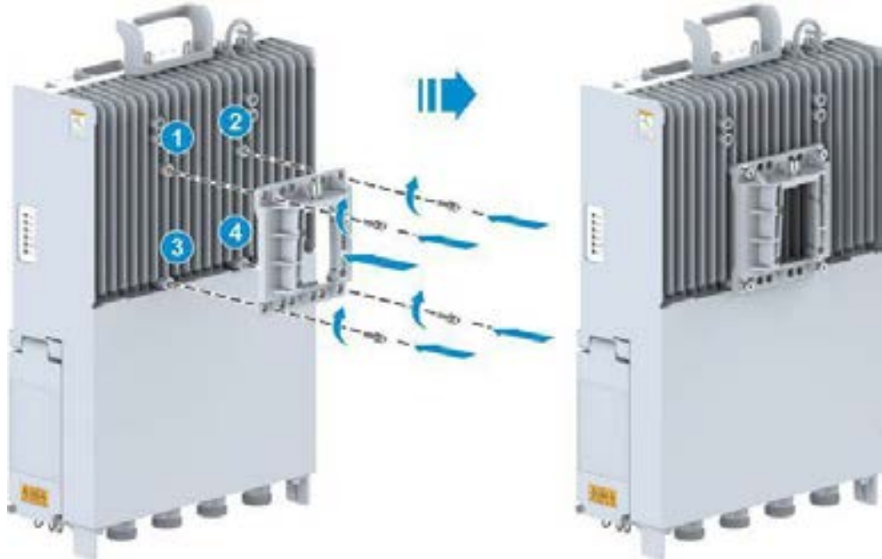
Şekil 8-10 RRU Desteğinin Monte Edilmesi (Ön Tarafтан Monte Ederek Kurulum)
