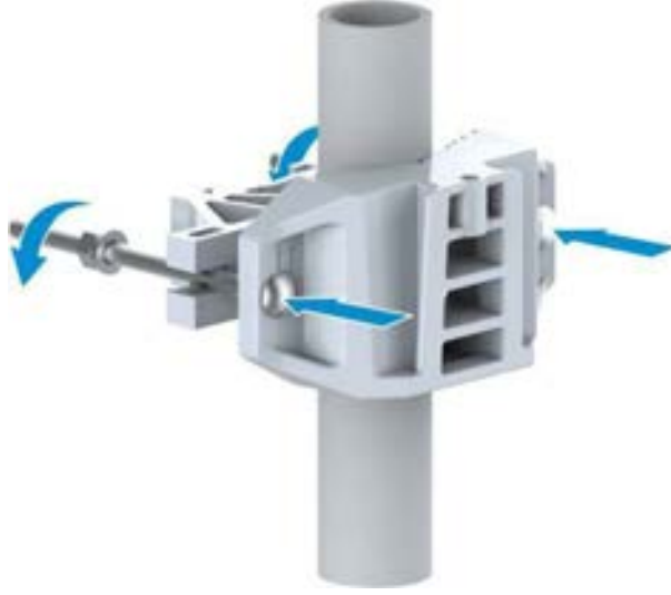
Şekil 9-12 Direk Montaj Düzeneğinin Kurulumu (2)
