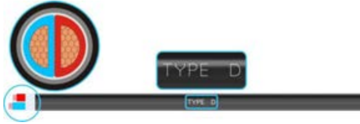
Şekil 3-7 D-şekilli tel DC güç kablosu
