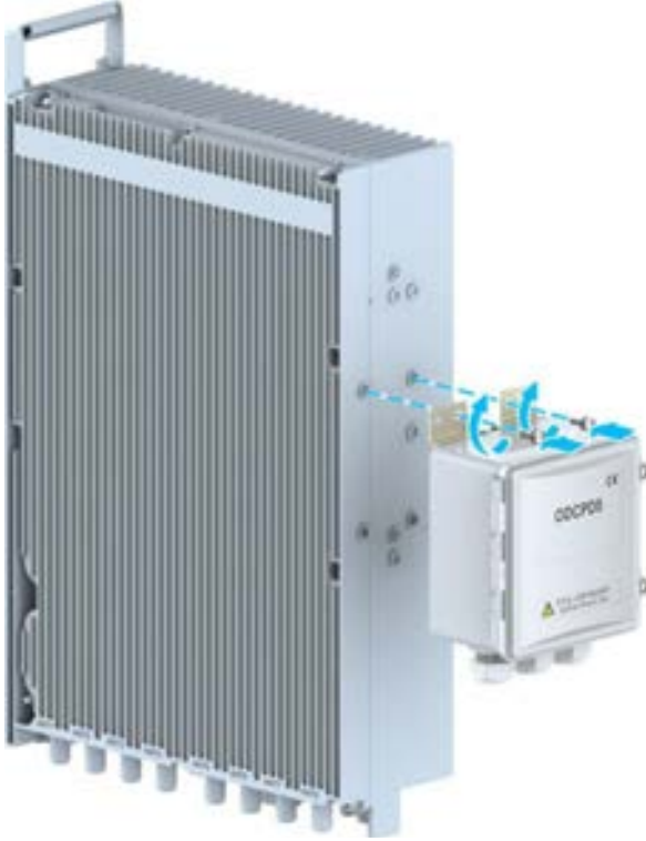
Şekil 10-15 Bir RRU'ya ODCPD5'in Kurulumu (2)
