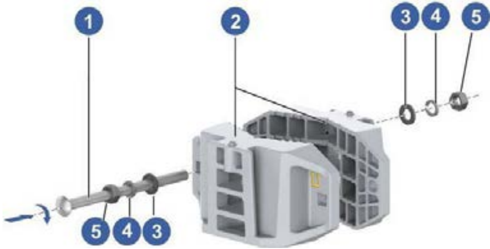
Şekil 9-21 Direk Montaj Düzeneğinin Kurulumu
