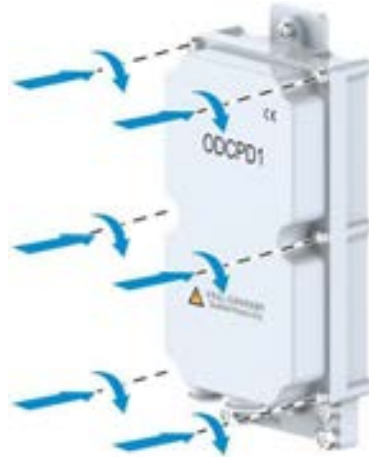
Şekil 10-8 Kapak Plakasının Kapatılması
