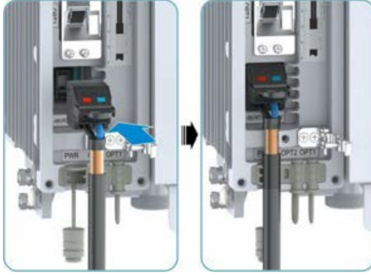
Şekil 11-14 Güç Kablosunun Takılması
