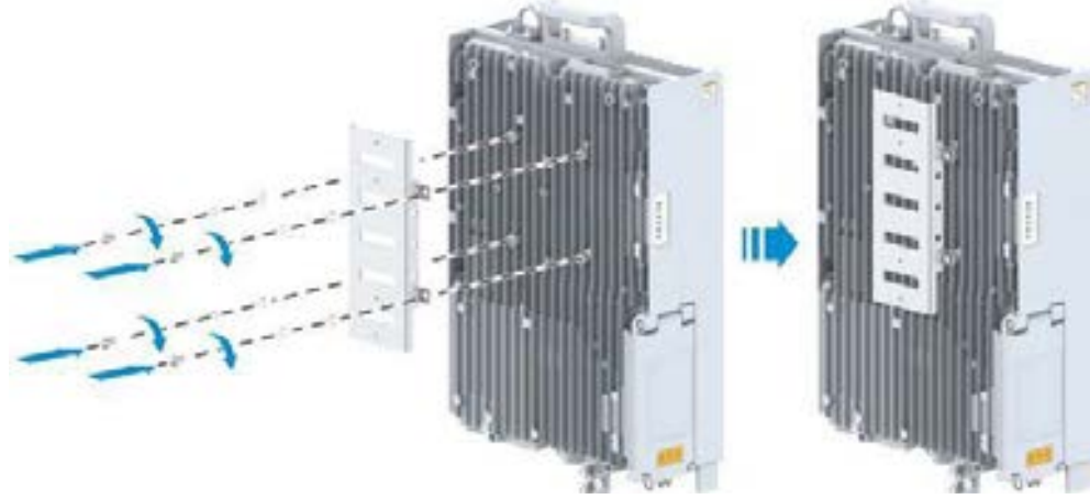
Şekil 10-3 ODCPD1'in Montaj Bağlantı Parçasının Bağlanması
