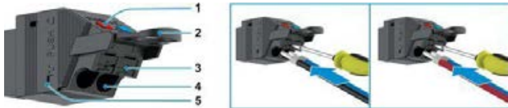
Şekil 6-12 Sıkıştırılmış Tüp Şeklindeki Terminallerin Takılması
