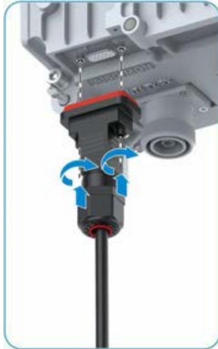
Şekil 11-21 AISG Kablosunun ZXSDR R8854'e Bağlanması
