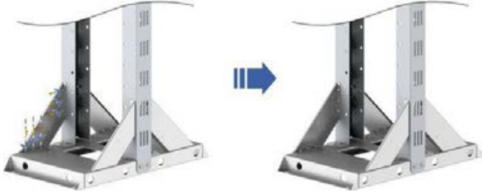
Şekil 16-17 Destek Plakasının Montajı
