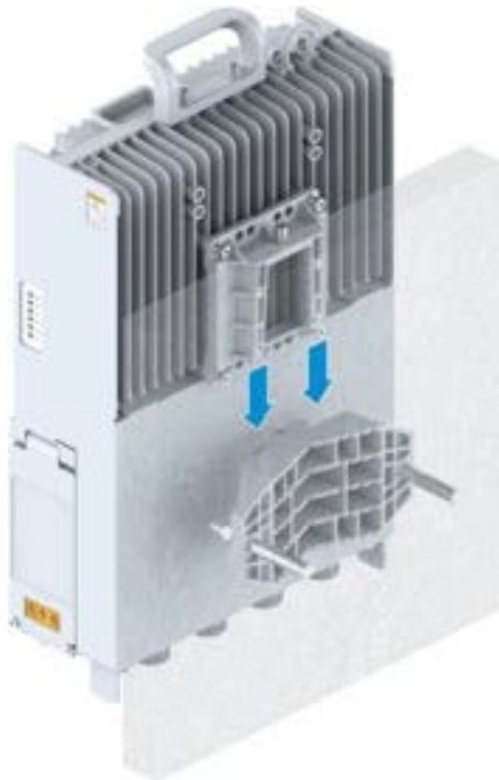
Şekil 9-39 RRU Desteğinin Sabitleme Klipsine Takılması
