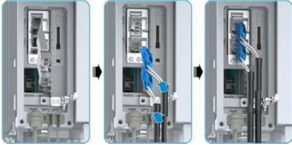
Şekil 11-7 Optik Modül ve Optik Fiber Kablonun Yerine Takılması
