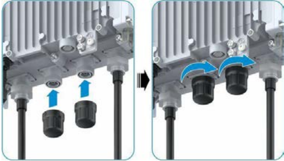
Şekil 12-1 Kullanılmayan Konnektörlerin Kontrol Edilmesi
