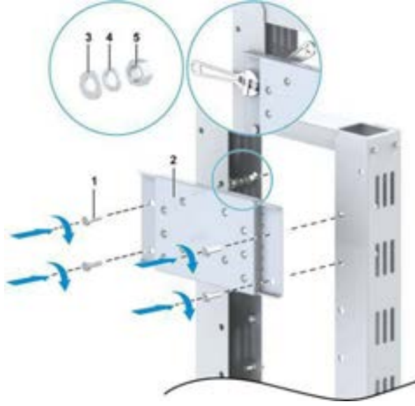
Şekil 8-42 Adaptör Plakanın/Levhanın Kurulumu
