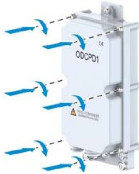
Şekil 9-7 Kapak Plakasının Kapatılması
