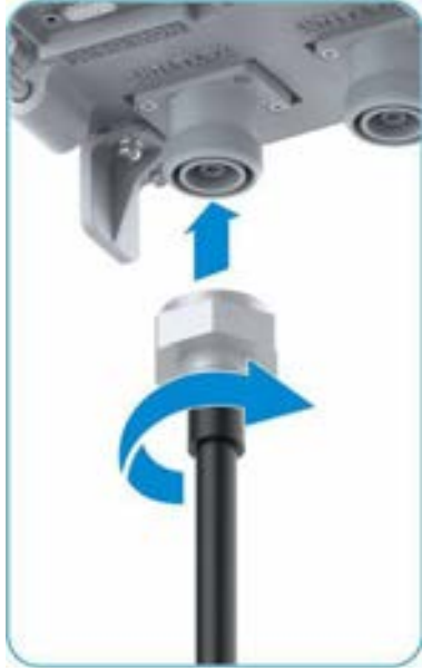
Şekil 10-3 Anten Besleme Kablolarının Kurulumu
