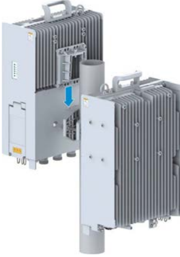
Şekil 8-19 Direk Montaj Düzeneği Üzerine RRU'ların Montajı
