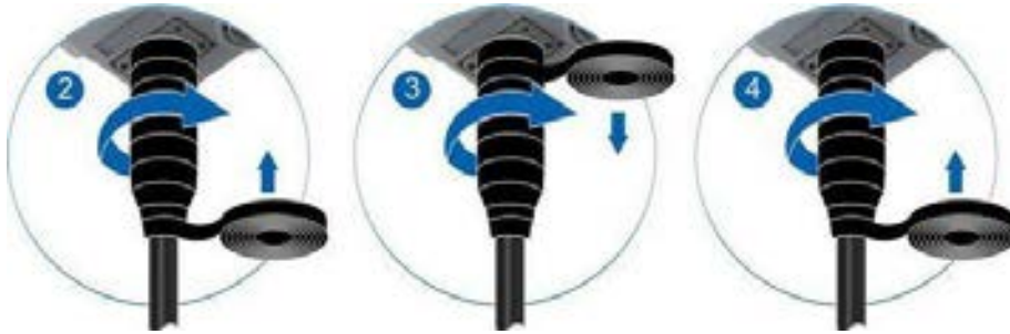
Şekil 15-9 Su Geirmez/Anti-Ultraviyole Bandın Sarılması
