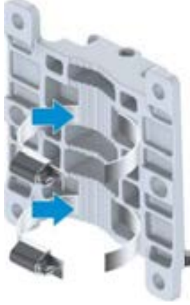
Şekil 8-30 Direk Çemberlerinin Sabitleme Klipsine Takılması
