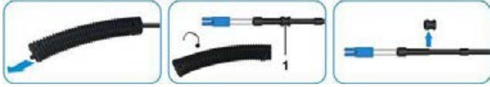
Şekil 10-19 Oluklu Boru ve Sürgünün Sökülmesi
