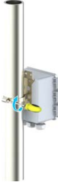
Şekil 9-19 Keleçe Üzerindeki Vidanın Sıkıştırılması
