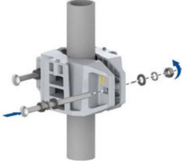
Şekil 8-22 Direk Montaj Düzeneğinin Kurulumu (1)
