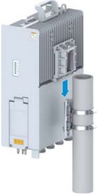
Şekil 8-33 ZXSDR R8854E'nin Montajı
