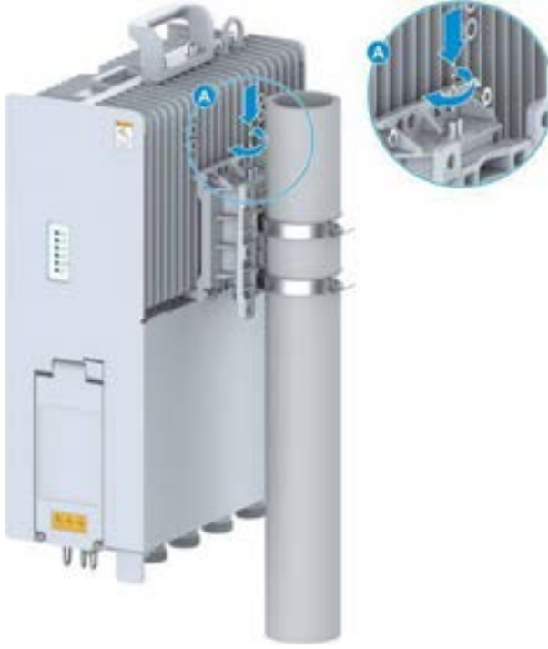
Şekil 8-34 Kilitleme Vidasının Sıkıştırılması
