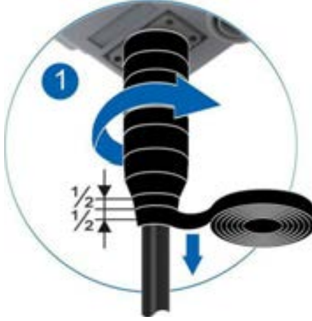
Şekil 15-8 Bir Kat Elektrik İzolasyon Bandının Sarılması
