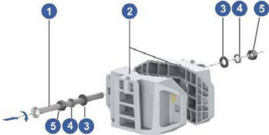
Şekil 8-21 Direk Montaj Düzeneğinin Kurulumu
