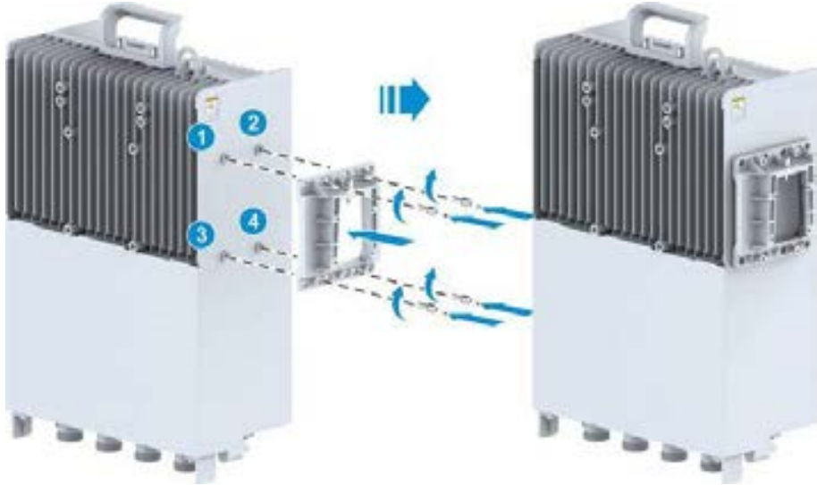
Şekil 7-11 RRU Desteğinin Monte Edilmesi (Yan Taraftan Monte Ederek Kurulum)
