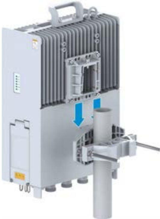
Şekil 8-13 Direk Montaj Düzeneği Üzerine RRU'nun Montajı
