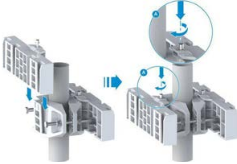
Şekil 8-25 Paralel Desteklerin Montaj İşlemi
