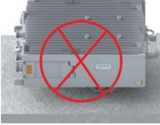
Şekil 7-16 RRU'nun Kurulumu Yatay Olarak Yapılmamalıdır
