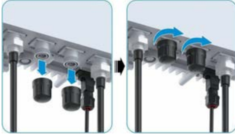
Şekil 11-1 Kullanılmayan Konnektörlerin Kontrol Edilmesi
