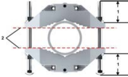
Şekil 8-18 Vida Montaj Pozisyonu
