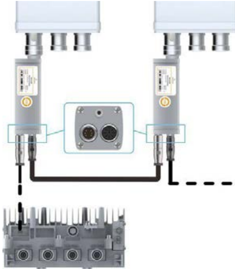
Şekil 10-7 AISG Kablosunun RCU'ya Bağlanması
