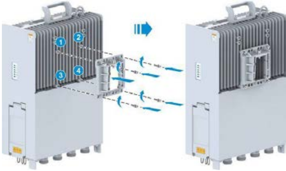
Şekil 7-10 RRU Desteğinin Monte Edilmesi (Ön Taraftan Monte Ederek Kurulum)
