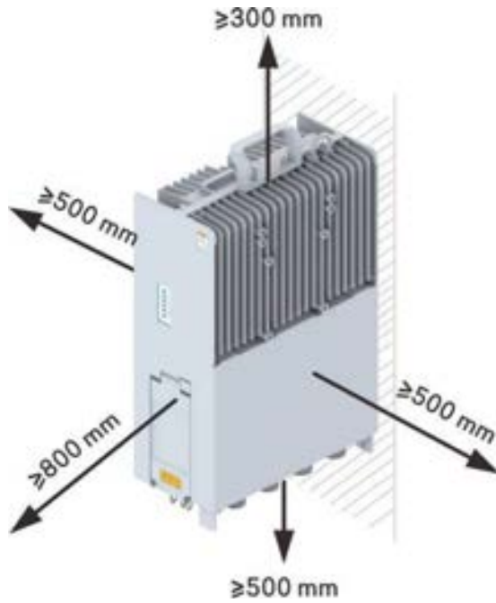
Şekil 7-3 Yan Taraftan Monteli Kurulum için Tavsiye Edilen Alan Gereksinimleri
