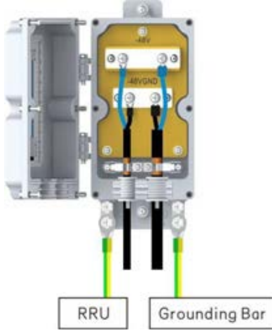
Şekil 9-8 Koruyucu Topraklama Kablosunun Topraklama Barasına Bağlanması (ODCPD1)
