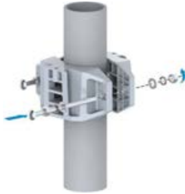
Şekil 8-16 Direk Montaj Düzeneğinin Kurulumu (1)
