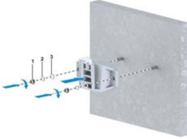
Şekil 8-38 Sabitleme Klipsinin Sıkıştırılması
