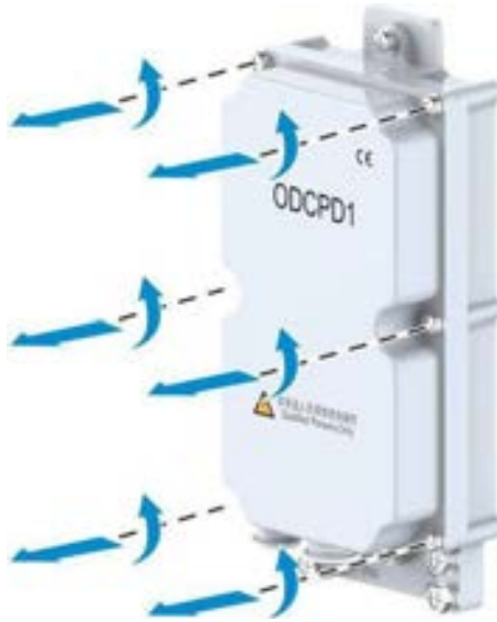
Şekil 9-4 ODCPD1'in Kapak Plakasının Açılması
