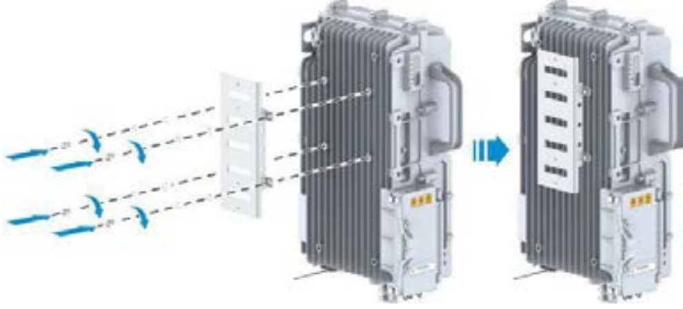
Şekil 10-41 PIMAC'ın Montaj Bağlantı Parçasının Bağlanması
