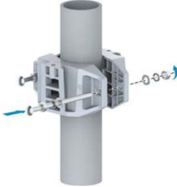
Şekil 9-22 Direk Montaj Düzeneğinin Kurulumu (1)
