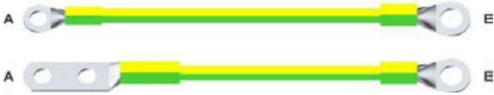
Şekil 3-1 Bir Koruyucu Topraklama Kablosunun Yapısı
