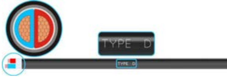
Şekil 3-7 D-şekilli tel DC güç kablosu
