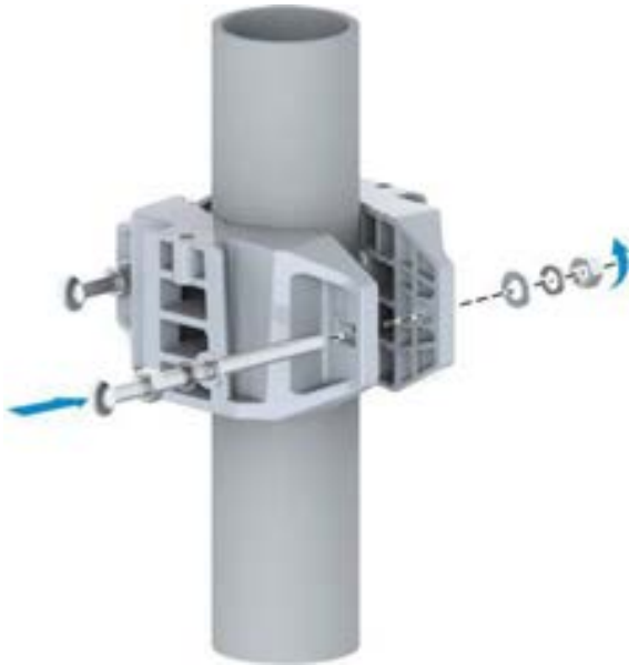
Şekil 9-16 Direk Montaj Düzeneğinin Kurulumu (1)
