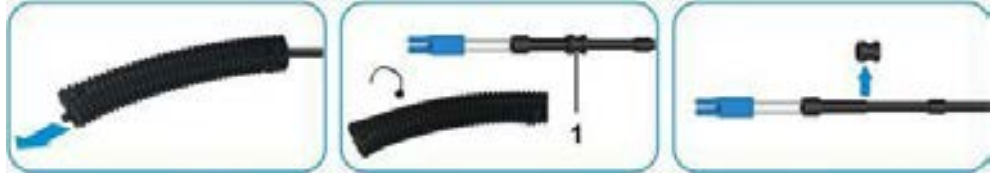
Şekil 11-6 Oluklu Boru ve Sürgünün Sökülmesi
