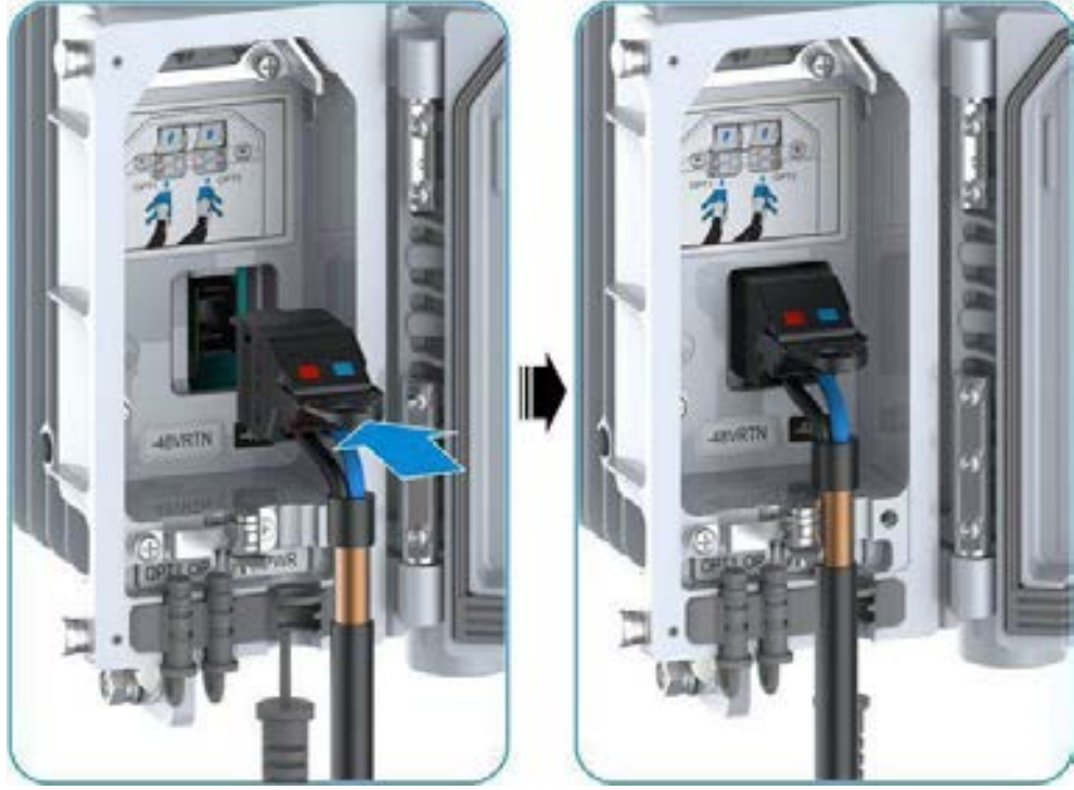
Şekil 11-14 Güç Kablosunun Takılması
