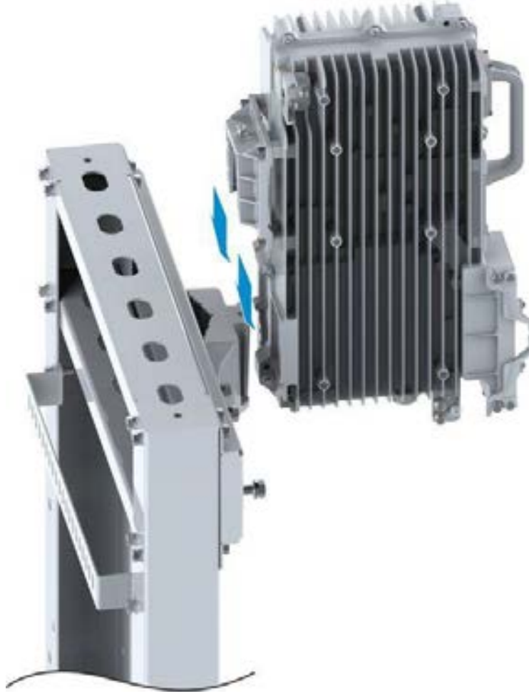
Şekil 9-47 L-Şekilli Destek Üzerine RRU'nun Kurulumu
