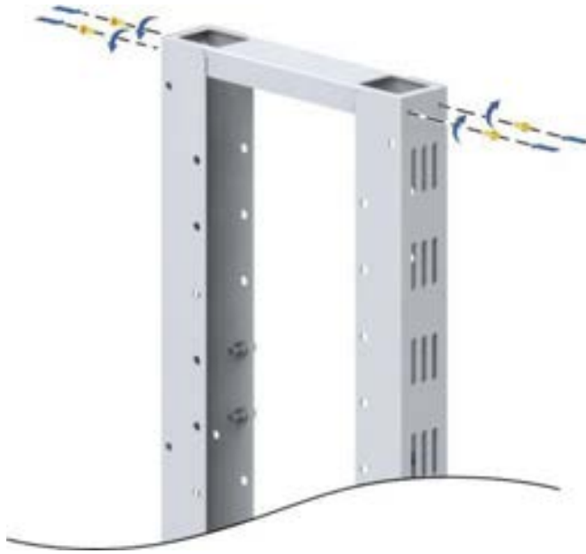
Şekil 18-2 Direk ve Üst Kirişin Sıkıştırılması
