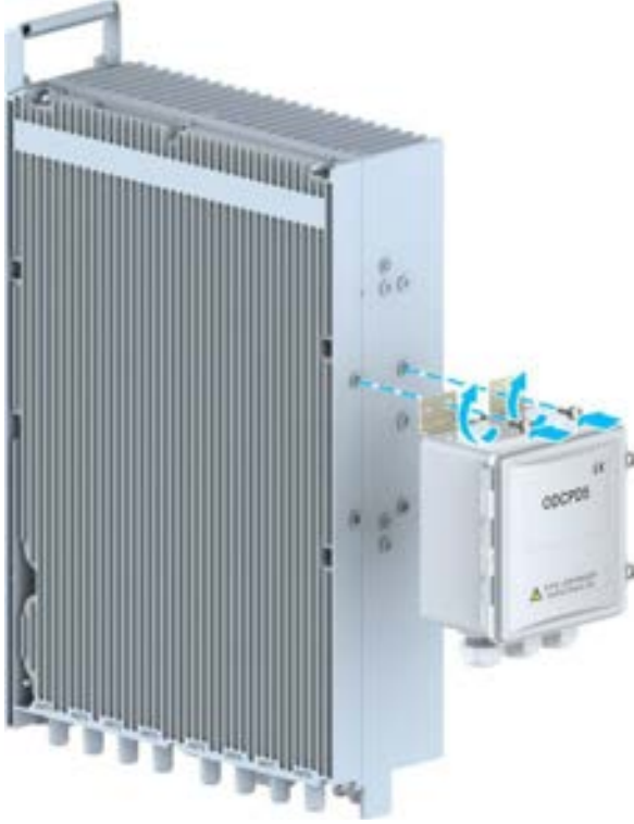
Şekil 10-15 Bir RRU'ya ODCPD5'in Kurulumu (2)
