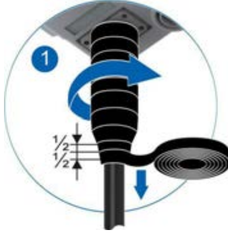
Şekil 17-6 Bir Kat Elektrik İzolasyon Bandının Sarılması
