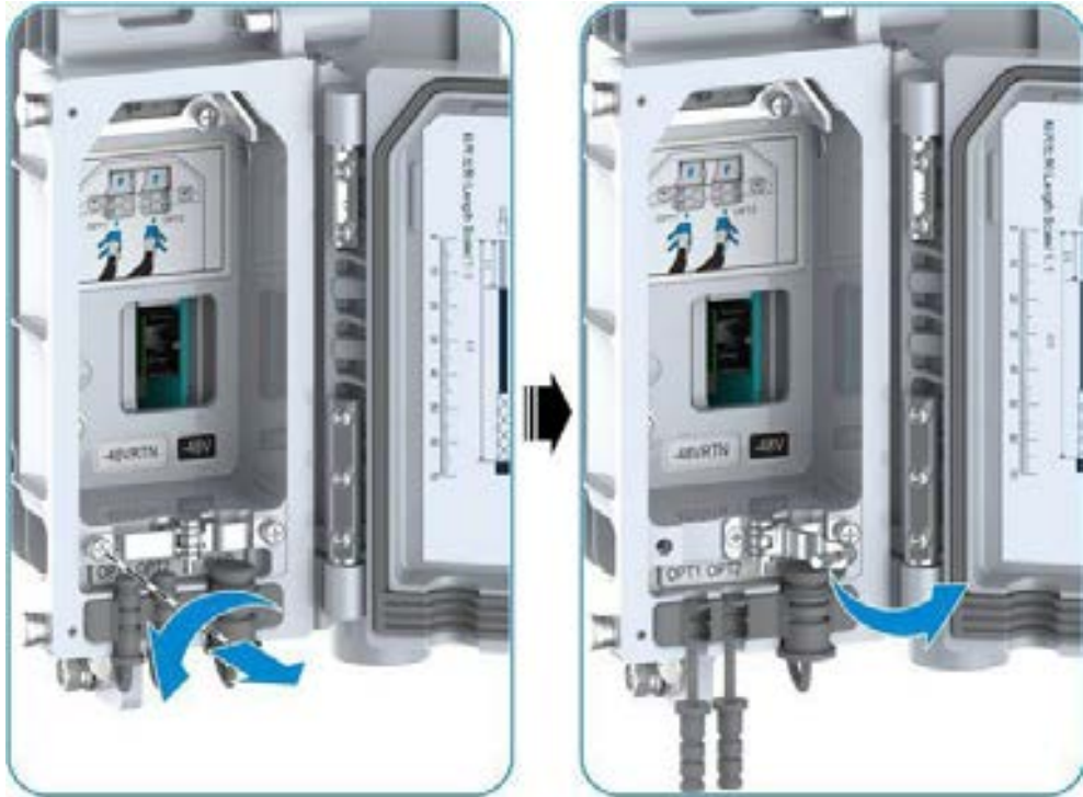
Şekil 11-5 Sıkıştırma Klipsinin Açılması
