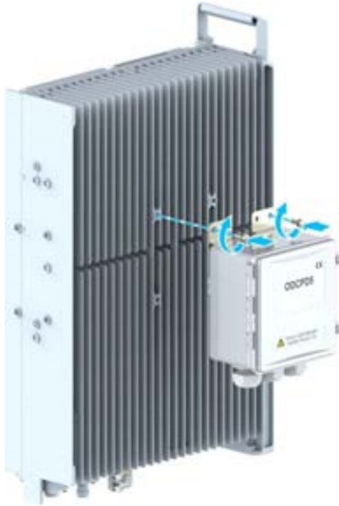
Şekil 10-14 Bir RRU'ya ODCPD5'in Kurulumu (1)
