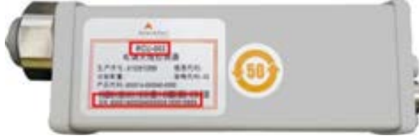
Şekil 11-22 RCU Bilgilerinin Kaydedilmesi
