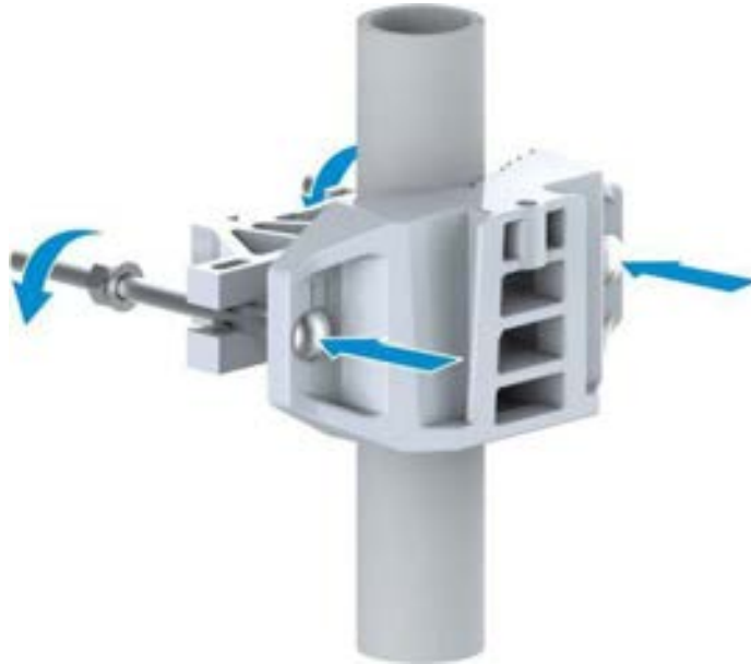
Şekil 9-12 Direk Montaj Düzeneğinin Kurulumu (2)
