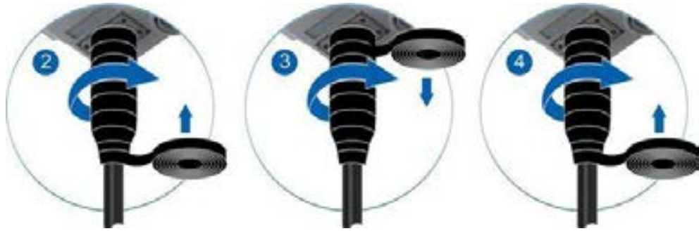
Şekil 17-7 Su Geçirmez/Anti-Ultraviyole Bandın Sarılması
