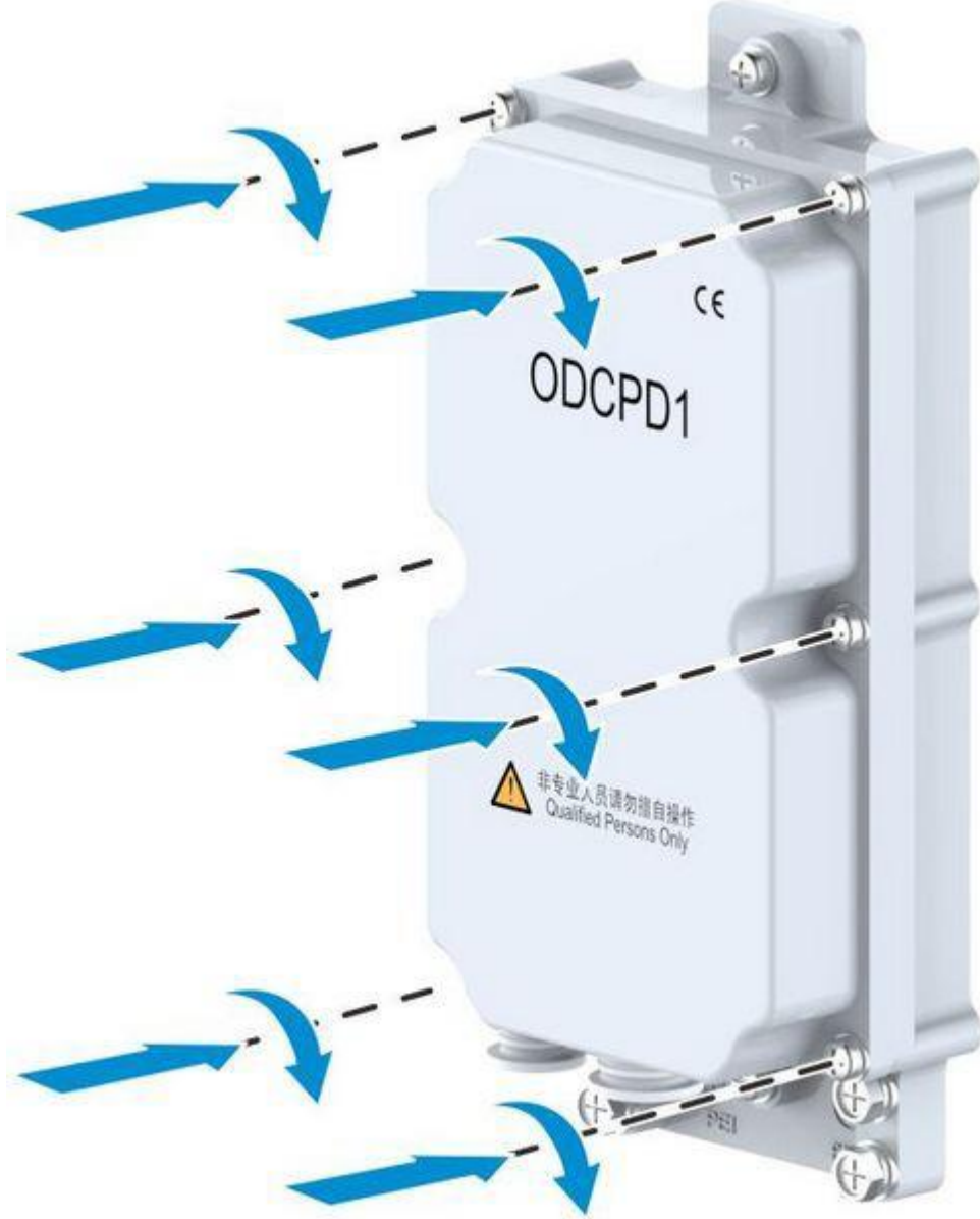
Şekil 10-8 Kapak Plakasının Kapatılması
