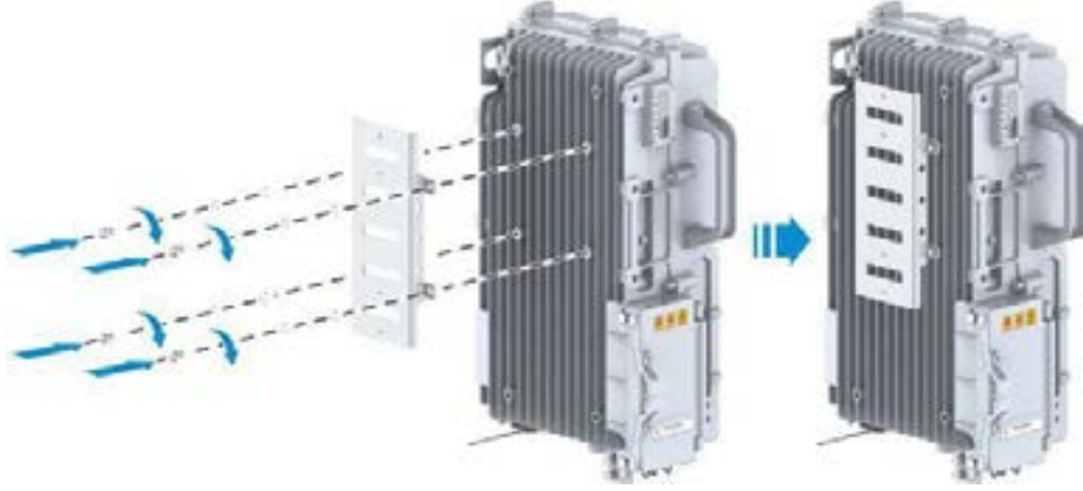
Şekil 10-3 ODCPD1'in Montaj Bağlantı Parçasının Bağlanması
