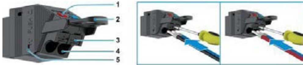
Şekil 11-12 Sıkıştırılmış Tüp Şeklindeki Terminallerin Takılması
