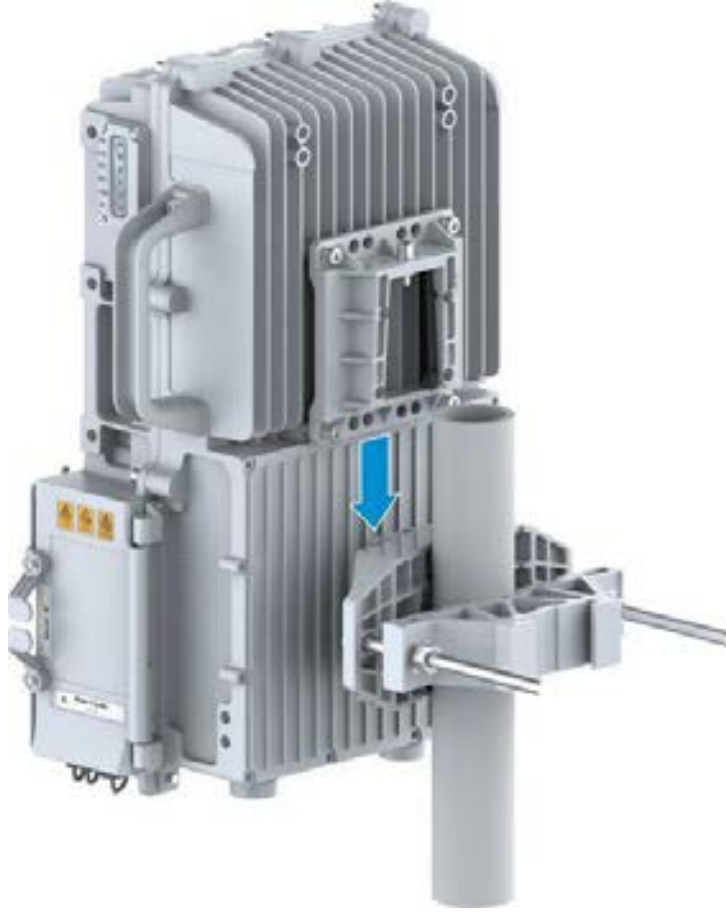
Şekil 9-13 Direk Montaj Düzeneđi Üzerine RRU'nun Montajı
