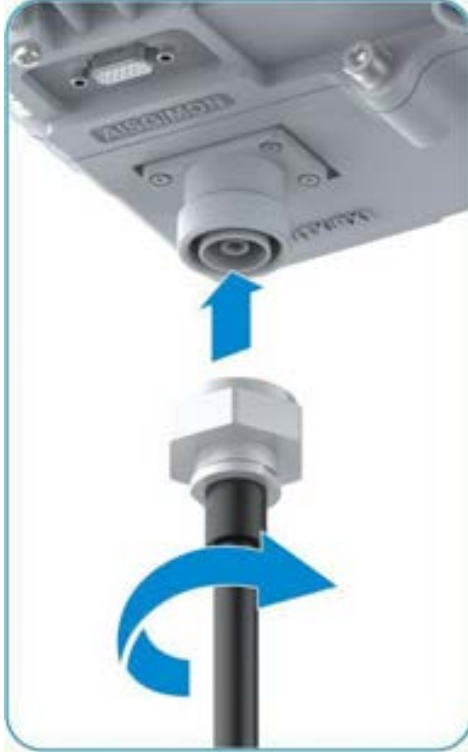
Şekil 3-3 Anten Besleme Kablosunun Bağlantısı
