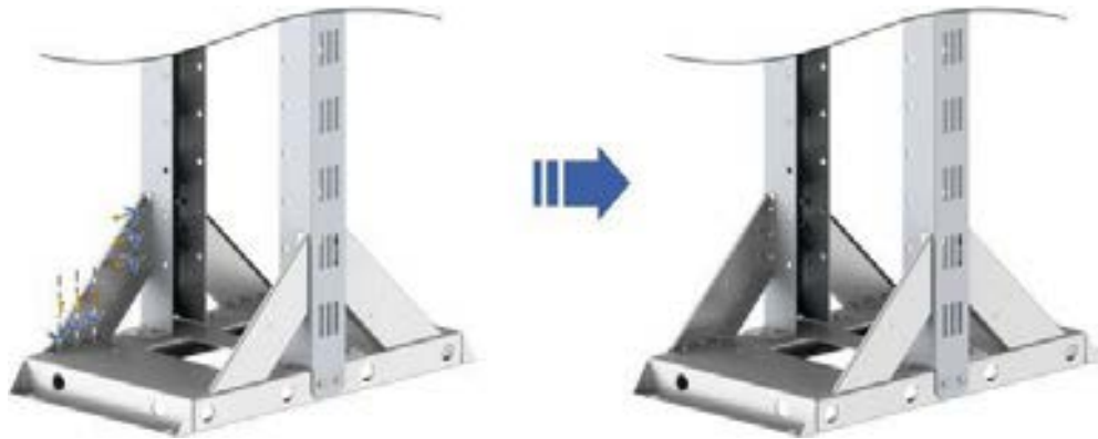
Şekil 18-3 Destek Plakasının Montajı
