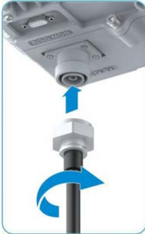
Şekil 11-3 Anten Besleme Kablolarının Kurulumu
