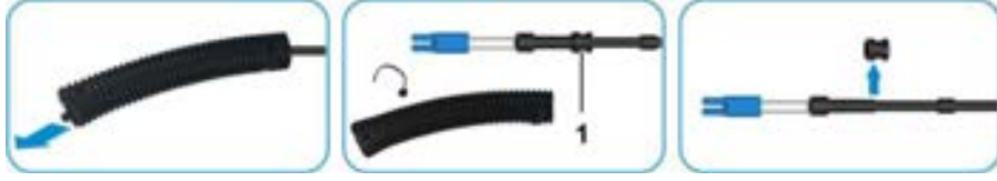
Şekil 11-19 Oluklu Boru ve Sürgünün Sökülmesi
