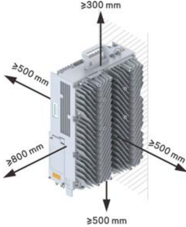
Şekil 8-10 Yan Taraftan Monteli Kurulum için Tavsiye Edilen Alan Gereksinimleri
