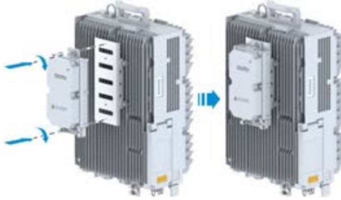
Şekil 10-2 ODCPD1 Bağlantı Kutusunun Sabitleilmesi
