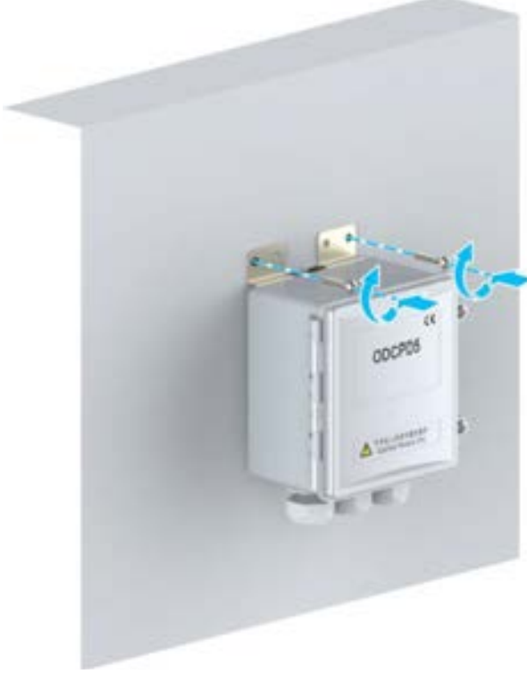
Şekil 10-22 ODCPD5'in Duvara Kurulumu
