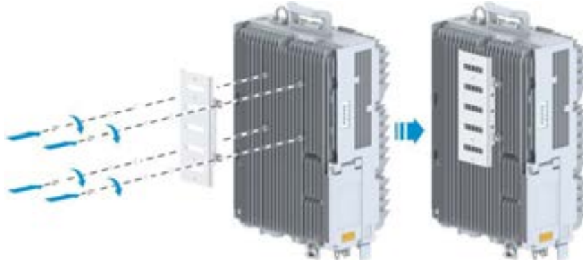
Şekil 10-1 ODCPD1'in Montaj Bağlantı Parçasının Sabitlenmesi
