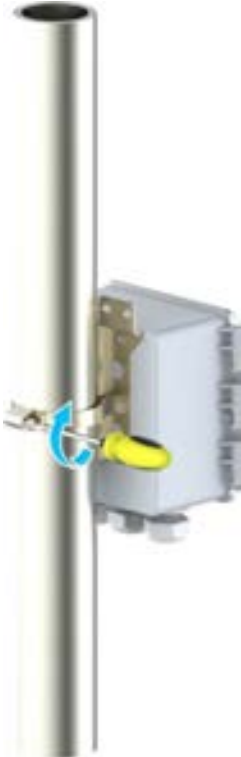
Şekil 10-18 Keleçe Üzerindeki Vidanın Sıkıştırılması
