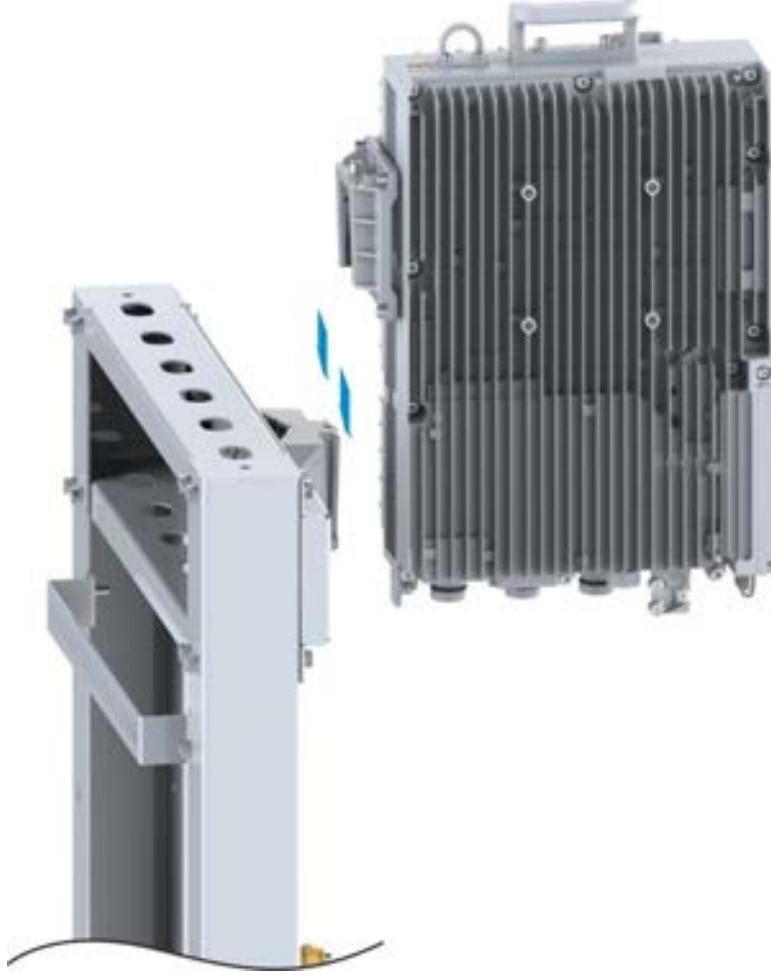
Şekil 9-30 L-Şekilli Destek Üzerine RRU'nun Kurulumu
