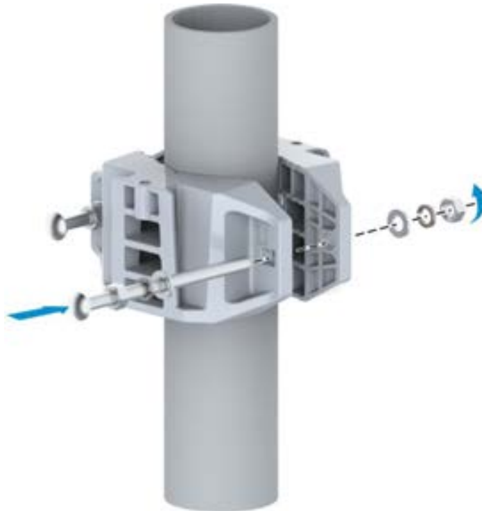
Şekil 9-20 Direk Montaj Düzeneğinin Kurulumu (1)
