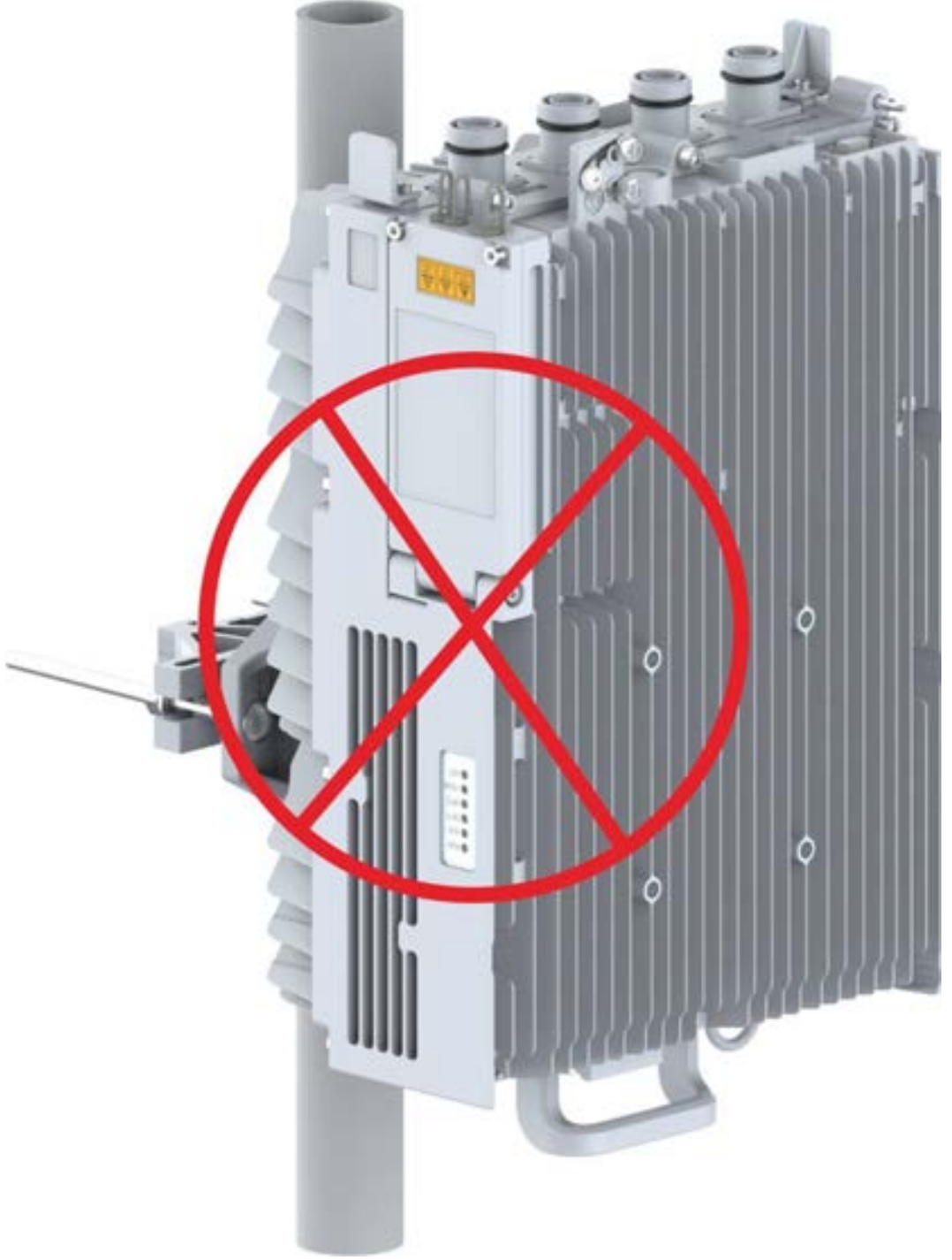
Şekil 8-6 Hiç Bir Portun Kurulumu Yukarıya Bakacak Şekilde Yapılmamalıdır
