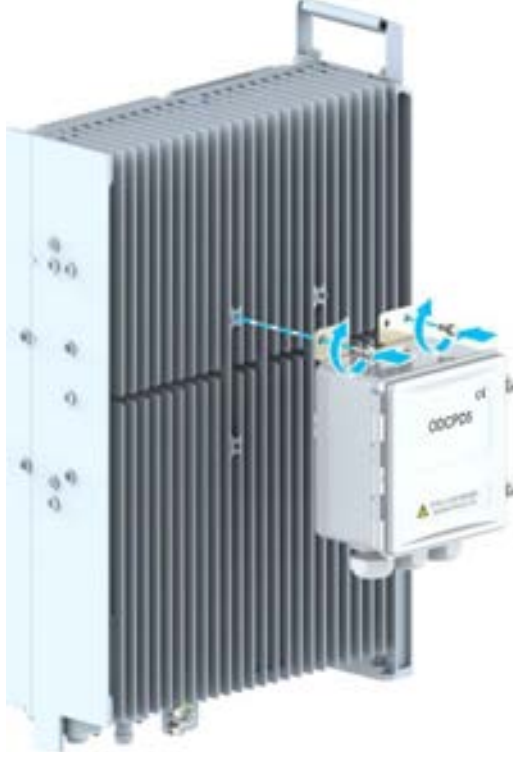
Şekil 10-13 Bir RRU'ya ODCPD5'in Kurulumu (2)
