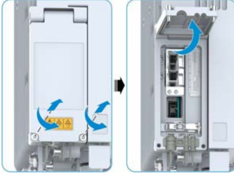
Şekil 11-17 Bakım Penceresinin Açılması
