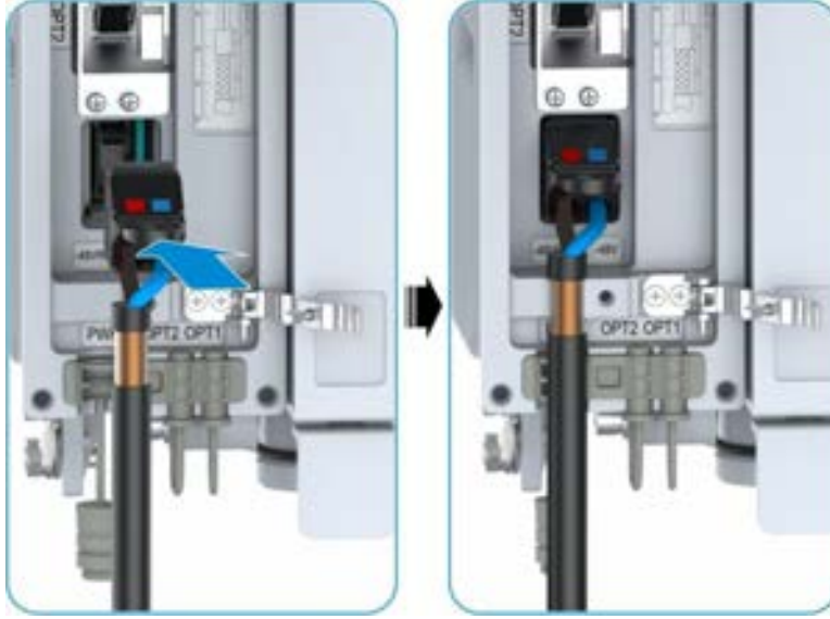
Şekil 11-27 Güç Kablosunun Takılması
