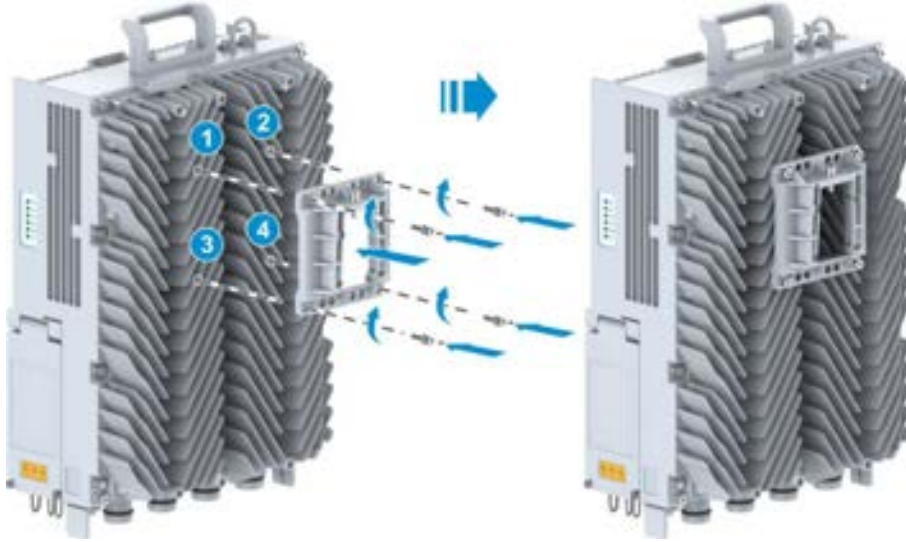
Şekil 8-1 RRU Desteğinin Monte Edilmesi (Ön Taraftan Monte Ederek Kurulum)
