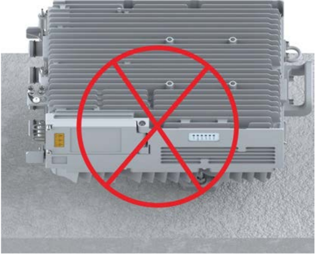
Şekil 8-7 RRU'nun Kurulumu Yatay Olarak Yapılmamalıdır
