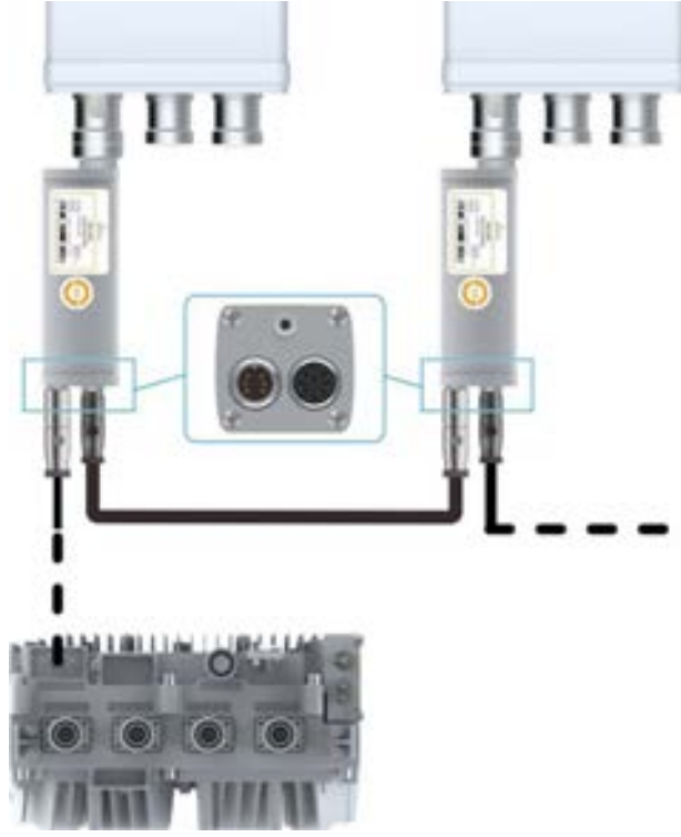
Şekil 11-7 AISG Kablosunun RCU'ya Bağlanması
