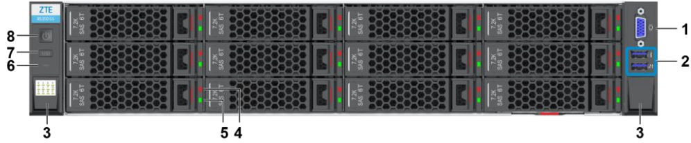
Şekil 2-1 On İki Yatay Disk Yuvalı Ön Panel
